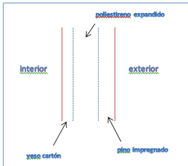
Ilustración 6: Estructura de pared
