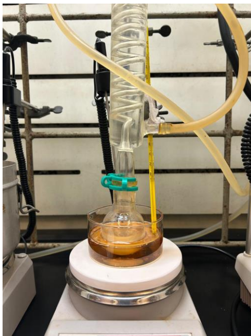
Figura 9. Montaje experimental utilizado para la funcionalización de nanopartículas de \text{SiO}_2 con APTES. El sistema consiste en un balón de fondo redondo con refrigerante de reflujo y agitación magnética, operado a una temperatura controlada de 70^\circ\text{C} .
