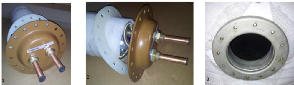
Figura 5.14: Instalación Intercambiador de Calor. Fuente 2
