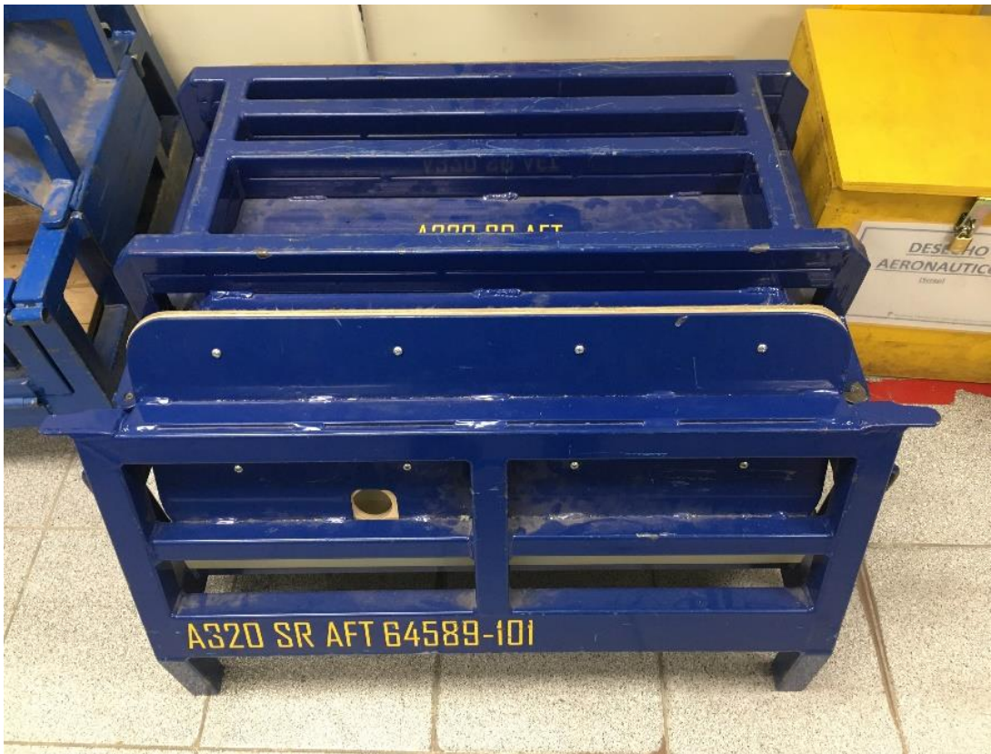
Figura A-10 Armazón de hierro tobogán-balsa de puerta AIRBUS 320 fixture.
