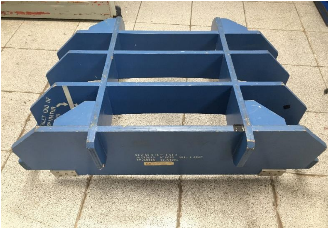
Figura A-16 Medidor de altura tobogán de puerta AIRBUS 320 fixture.
