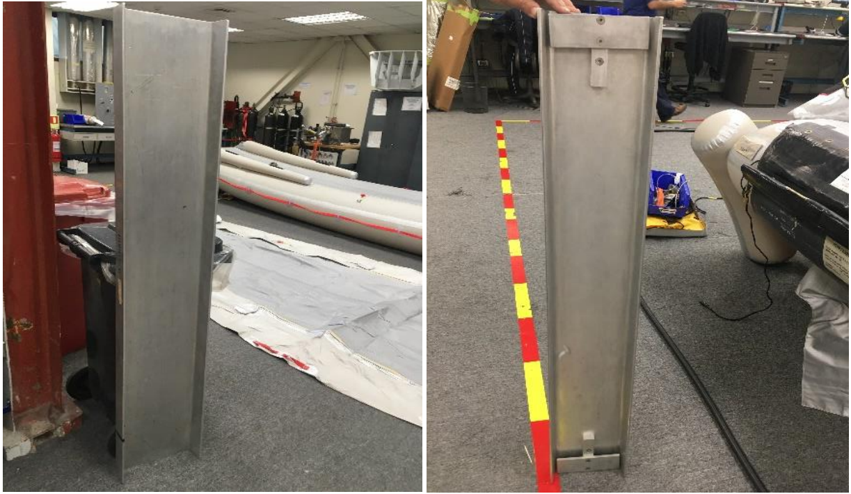
Figura A-21 Planchas de acero usadas para el prensado de los toboganes BOEING 767 fixture.
