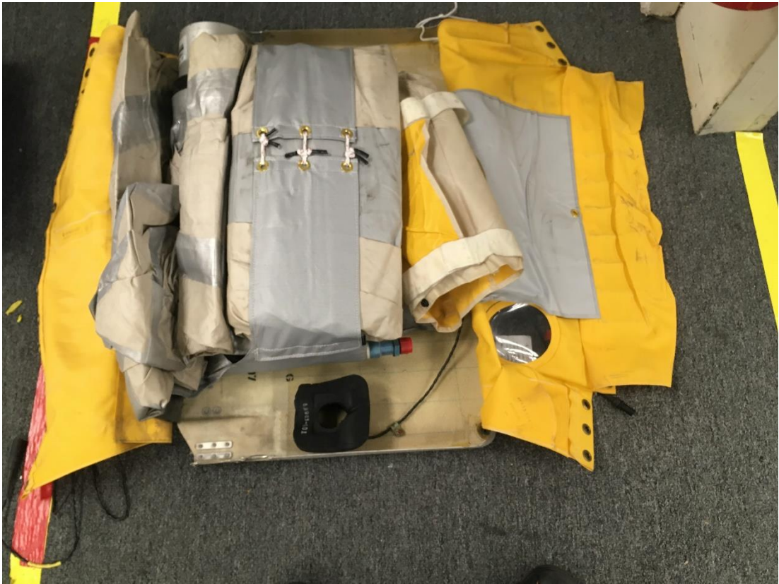
Figura A-3 Tobogán de puerta trasera AIRBUS 319/320 P/N D31516-717 y S/N: M10515
