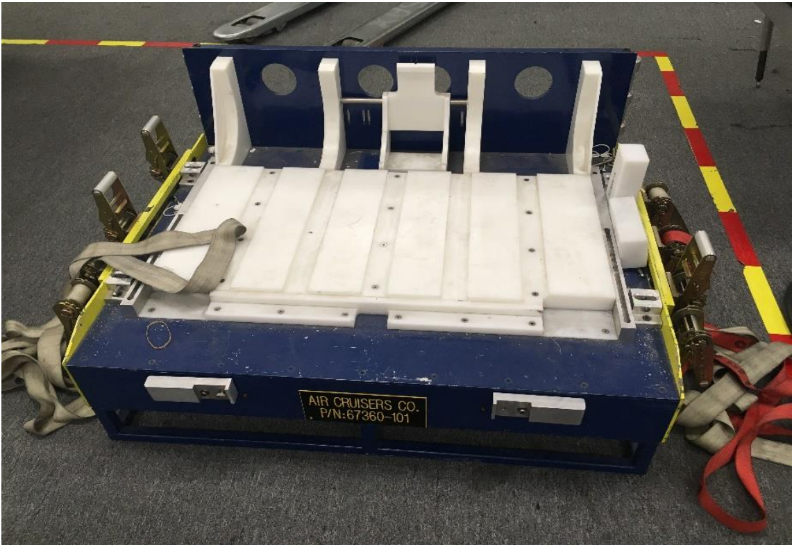
Figura A-20 Armazón de acero de tobogán de puerta Double Lane BOEING 787 fixture.
