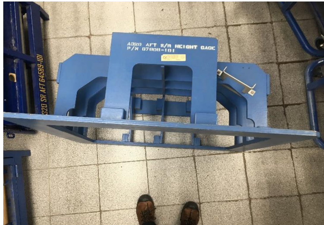
Figura A-11 Medidor de altura tobogán-balsa AIRBUS 320 fixture.
