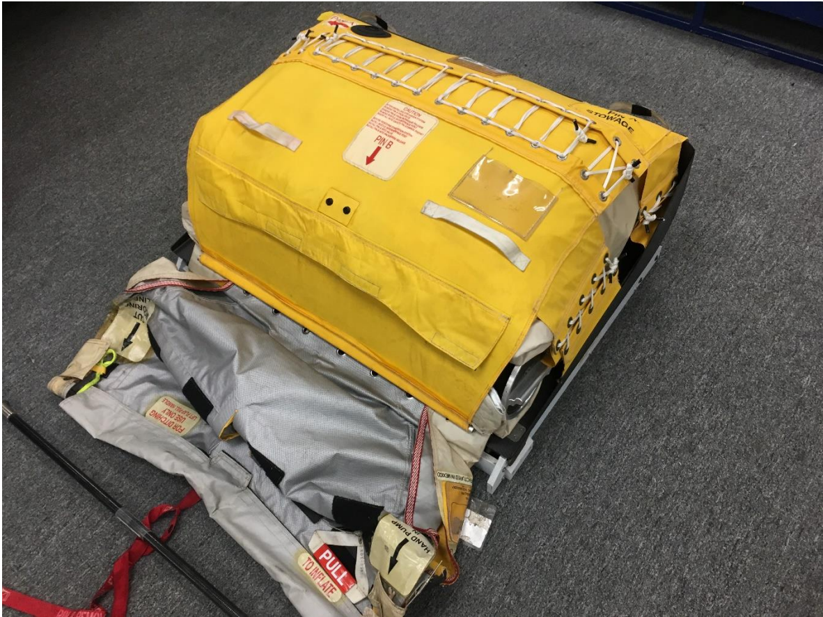
Figura A-5 Tobogán de largo alcance Double Lane BOEING 787 P/N 66574-201 y S/N 66574-M8132
