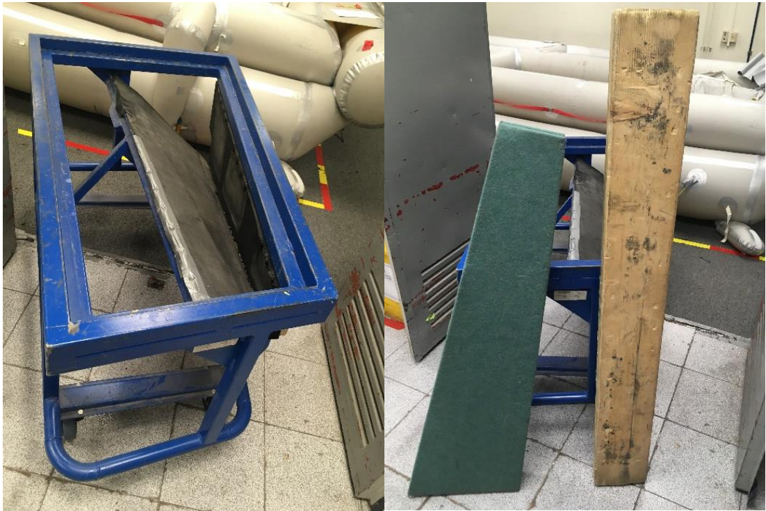
Figura A-18 Armazón de hierro – cubierta tapizada – Liston de madera de tobogán de ala AIRBUS 320 fixture.
