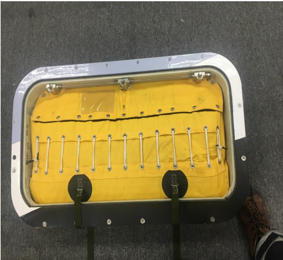
Figura A-4 Tobogán de puerta delantera AIRBUS 321 P/N 62292-107 y S/N M8522.
