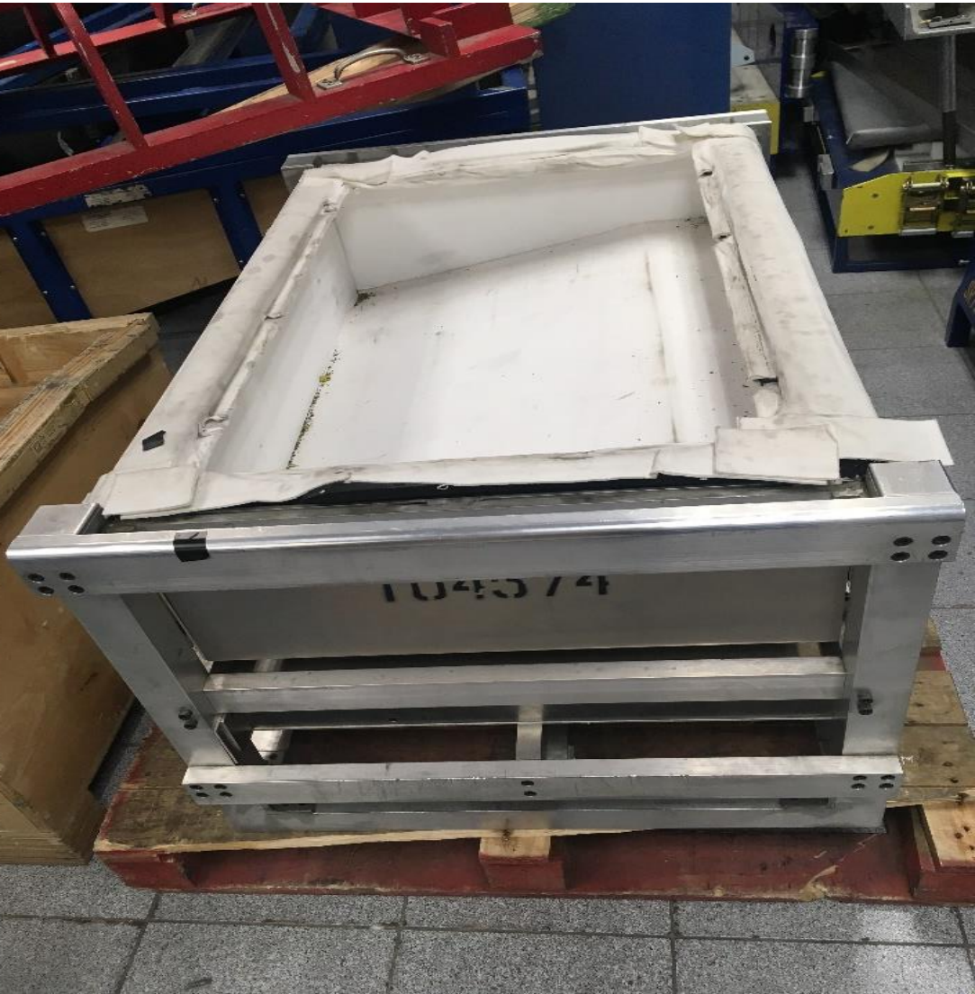
Figura A-12 Armazón de acero tobogán de puerta AIRBUS 321 fixture.
