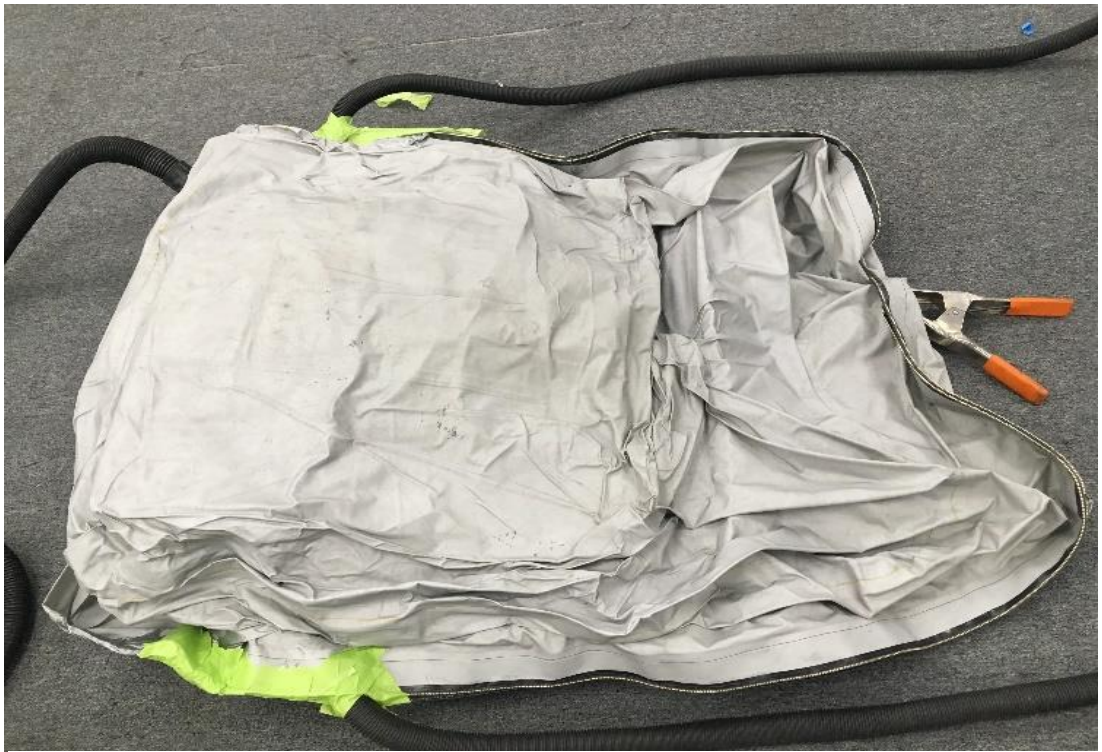
Figura A-17 Capa para succión tobogán puerta principal BOEING 767 fixture.
