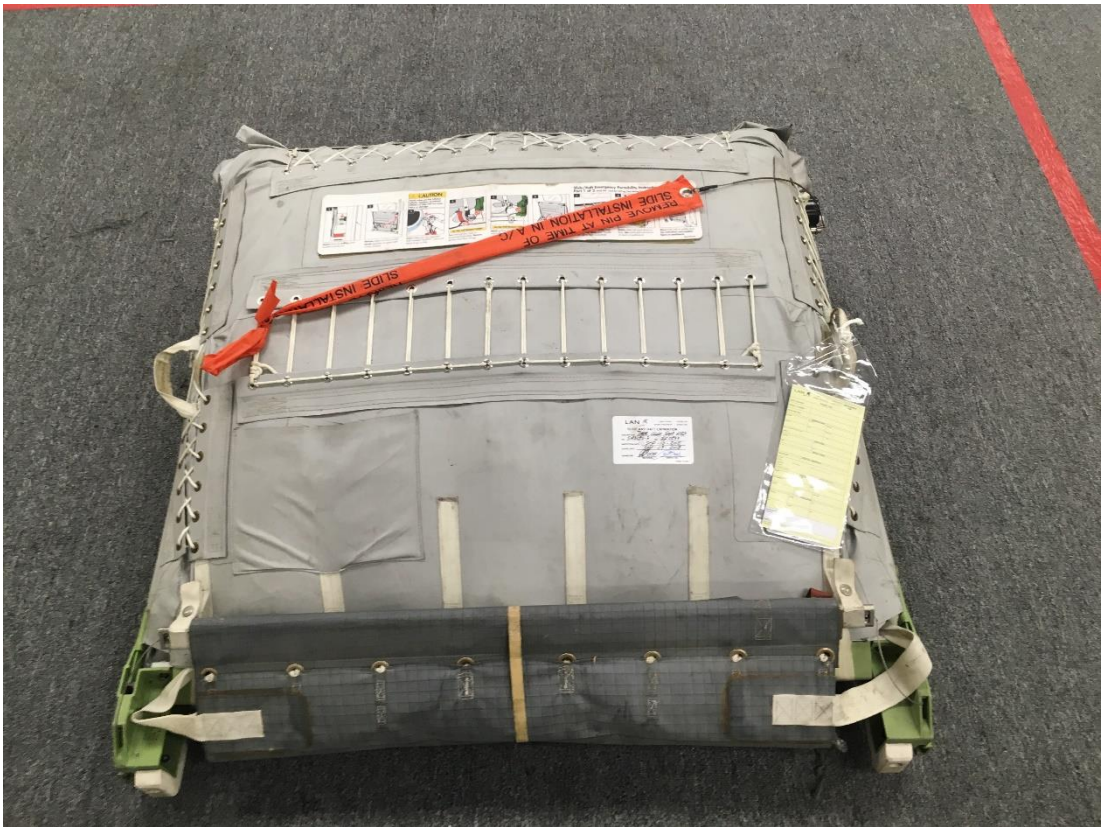
Figura A-2 Tobogán de puerta principal BOEING 767 P/N 5A3295-7 y S/N: SF0854.
