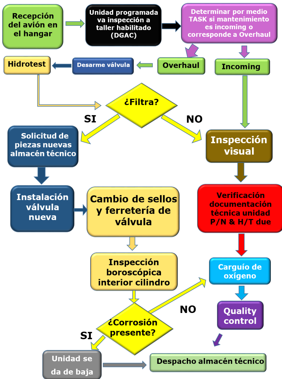
Figura 2-2 Proceso mantenimiento para cilindro de oxígeno general LATAM Airlines
