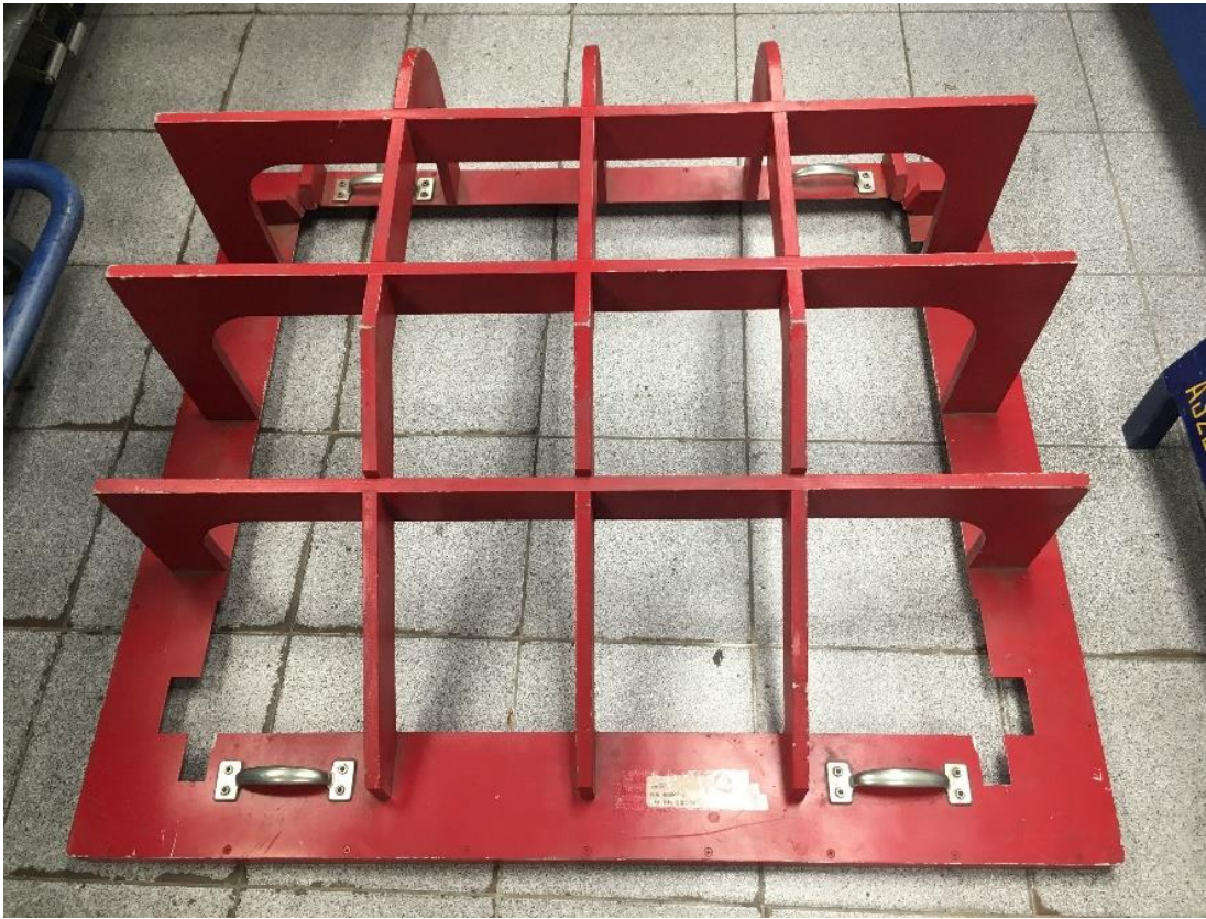
Figura A-13 Medidor de altura tobogán de puerta principal BOEING 767 fixture.
