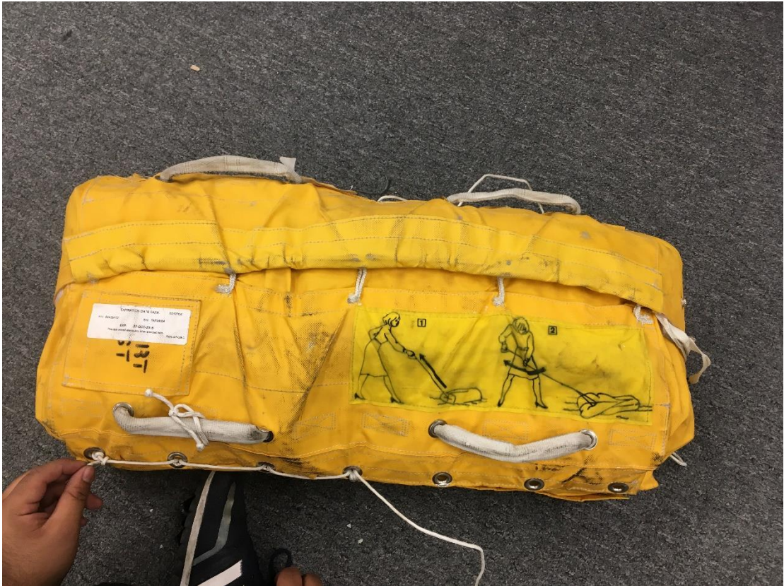
Figura A-6 Balsa de compartimento de emergencia AIRBUS 320 P/N R0372A301 y S/N TAG25028.
