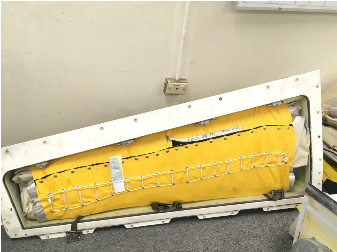
Figura A-1 Tobogán de ala BOEING 767 P/N 65563-102 y S/N 65563-0053
