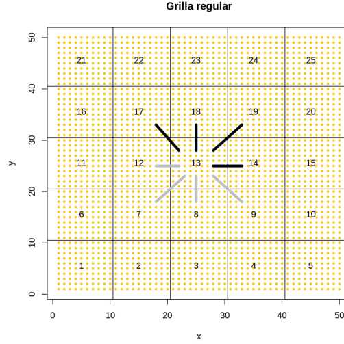
Figura 2.1: Se divide el dominio espacial en bloques regulares. Cada bloque se comunica por pares con cada uno de sus vecinos, un bloque interior tiene ocho vecinos. El bloque con índice 13 tiene cuatro vecinos con índices superiores (líneas negras).
