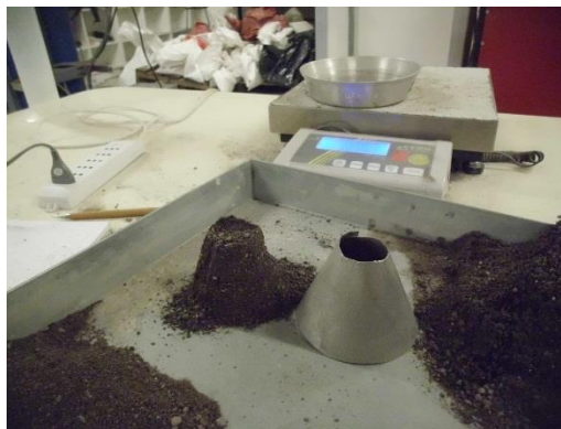
Figura 94 Arena en condición s.s.s.
