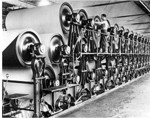
Fig. 1.4 Sección de secado de una antigua máquina de fabricación de papel tipo Fourdrinier
