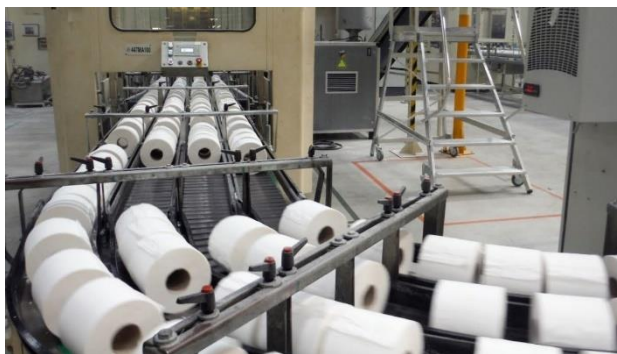
4.3 Línea de producción de rollos de papel en una de las cursadoras
