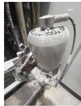
Fig. 2.2 Motor en posición vertical con polvo
