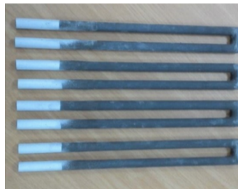
Figura 2.4: Resistencias de carburo de silicio tipo U . (Fuente: Volkwein (2016))
