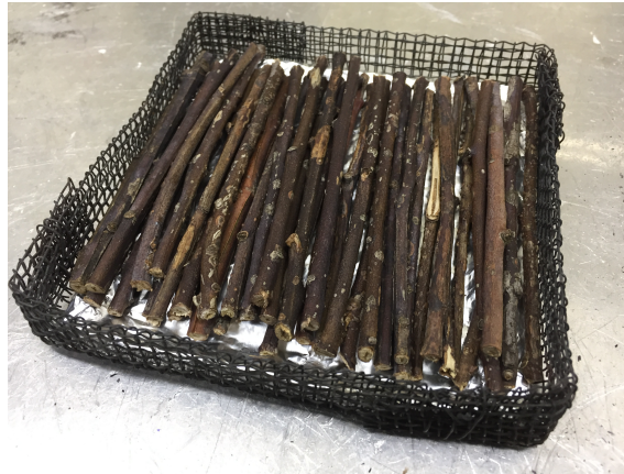
Figura 3.5: Sample holder con una muestra de ramas de eucalipto.
