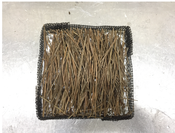
Figura 3.7: Sample holder con una muestra de hojas de pino.
