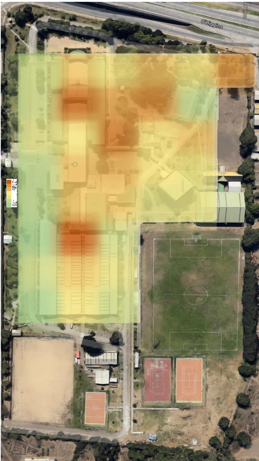
Figura 3.4. Mapa de calor creado en base a mediciones con analizador de espectro.
