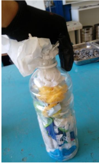
Fotografía 2-6. Incorporación de bolsas plásticas. Fuente: Propia
