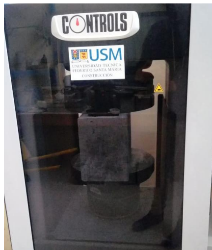
Fotografía 3-14. Bloque convencional en la prensa. Fuente: Propia
