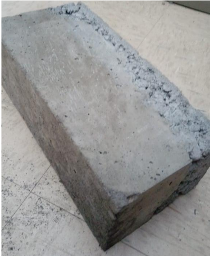
Fotografía 3-9. Bloque con eco-ladrillo después de ensayar a los 14 días. Fuente: Propia
