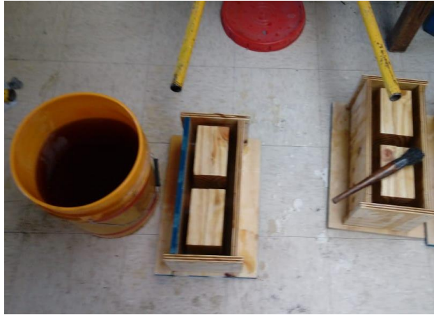
Fotografía 2-16. Aplicación de desmoldante. Fuente: Propia
