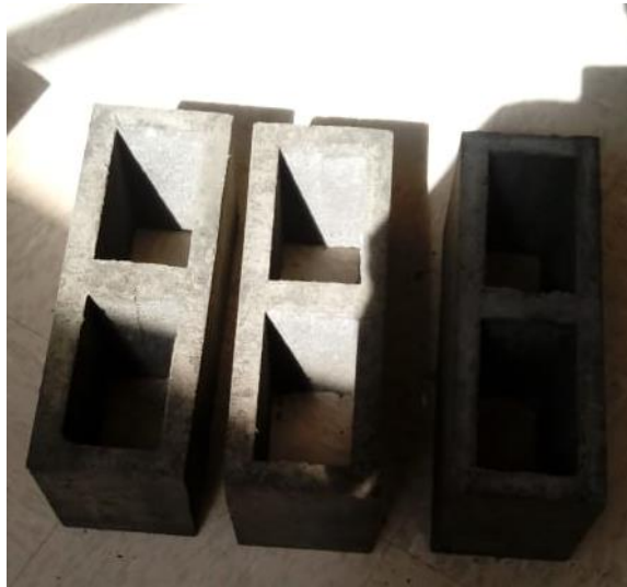
Fotografía 2-31. Bloques de hormigón convencionales desmoldados. Fuente: Propia
