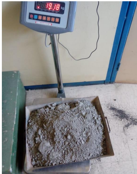
Fotografía 2-20. Dosificación del cemento. Fuente: Propia
