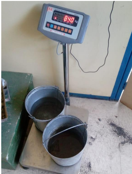
Fotografía 2-21. Dosificación del agua. Fuente: Propia
