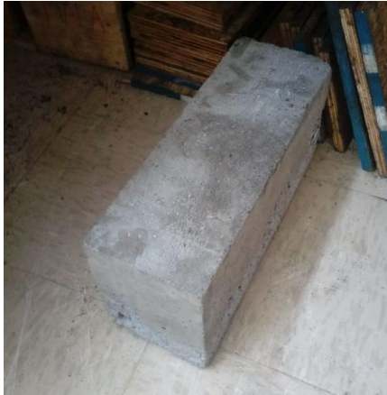
Fotografía 3-5. Bloque con eco-ladrillo antes de ensayar a los 14 días.
