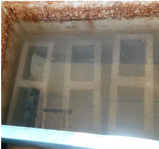
Fotografía 2-34. Curado de los Bloques convencionales. Fuente: Propia
