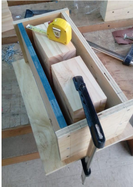
Fotografía 2-9. Moldaje confeccionado Fuente: Propia
