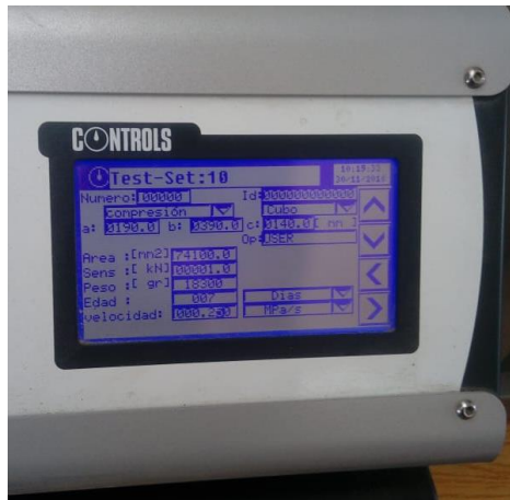
Fotografía 3-3. Registro de datos en el equipo. Fuente: Propia
