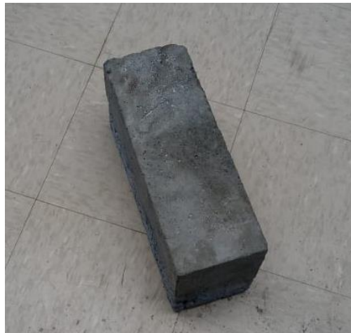
Fotografía 3-10. Bloque con eco-ladrillo antes de ensayar a los 28 días. Fuente: Propia
