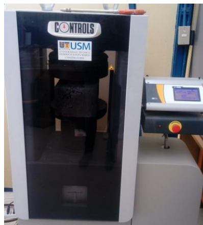
Fotografía 3-2. Bloque con eco-ladrillo en la prensa. Fuente: Propia
