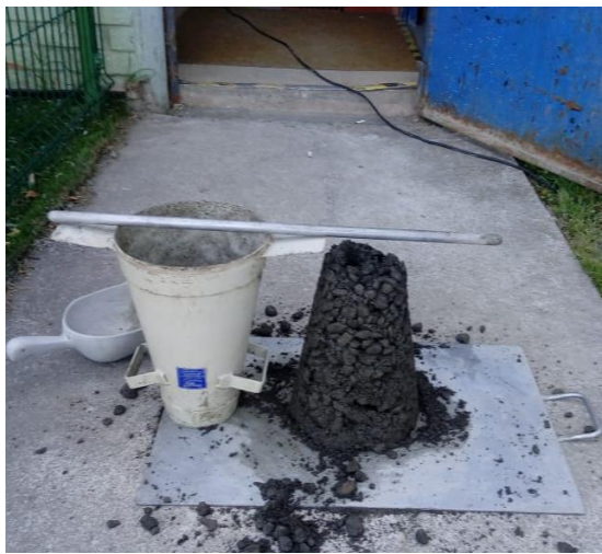
Fotografía 2-23. Ensayo del cono de Abrams. Fuente: Propia
