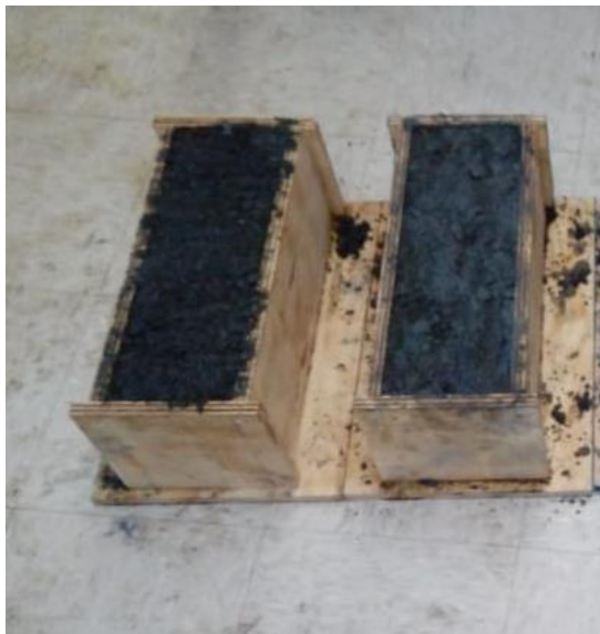
Fotografía 2-24. Moldaje hormigonado. Fuente: Propia
