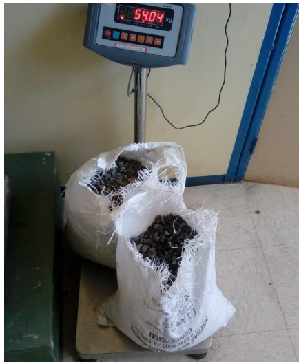
Fotografía 2-18. Dosificación de la grava. Fuente: Propia
