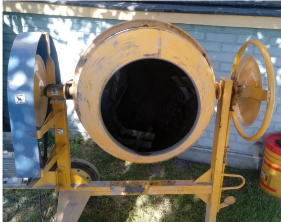
Fotografía 2-22. Amasado del hormigón.
