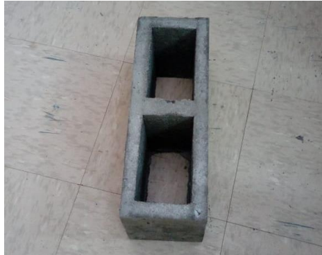
Fotografía 3-13. Bloque convencional antes de ensayar a los 7 días. Fuente: Propia
