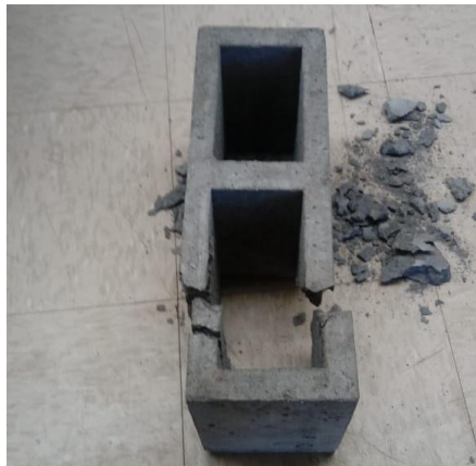
Fotografía 3-22. Bloque convencional después de ensayar a los 14 días Fuente: Propia
