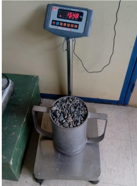
Fotografía 2-12. Registro de la masa de la grava aparente compacta. Fuente: Propia
