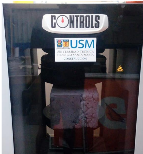
Fotografía 3-6. Bloque con eco-ladrillo en la prensa.
