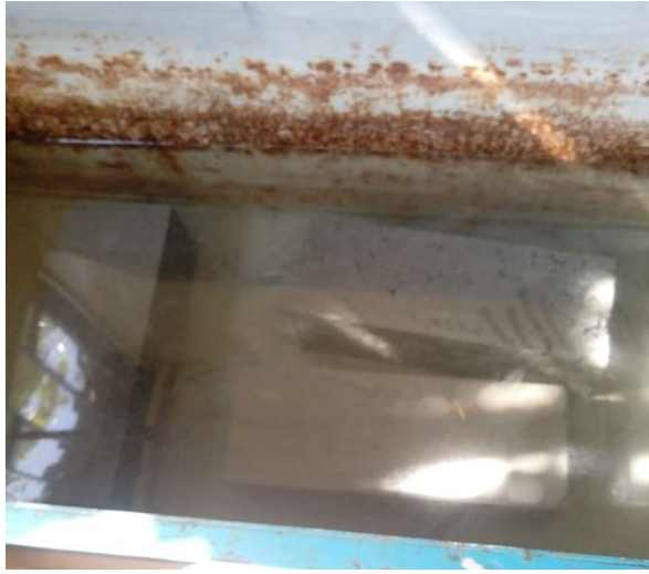
Fotografía 2-33. Curado de los bloques con eco-ladrillo. Fuente: Propia
