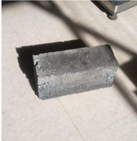
Fotografía 3-1. Bloque con eco-ladrillo antes de ensayar a los 7 días. Fuente: Propia
