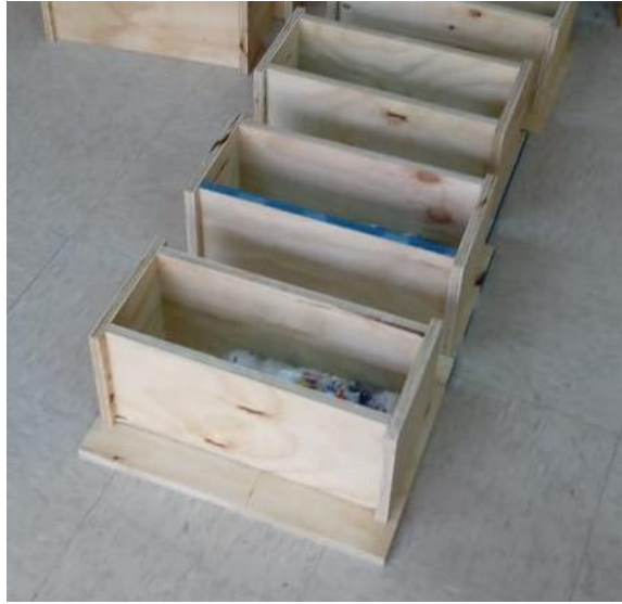
Fotografía 2-8. Moldaje confeccionado. Fuente: Propia
