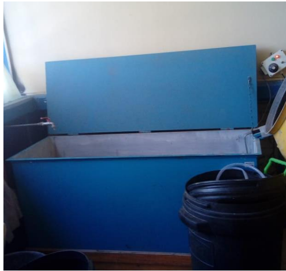
Fotografía 2-32. Cámara de curado. Fuente: Propia
