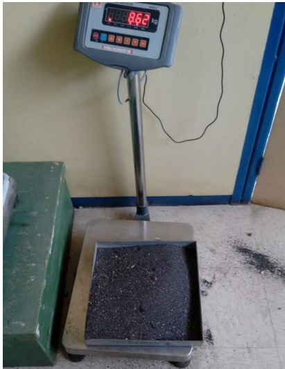
Fotografía 2-19. Dosificación de la arena. Fuente: Propia
