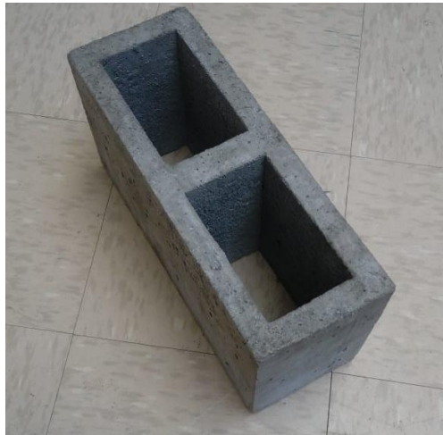
Fotografía 3-18. Bloque convencional antes de ensayar a los 14 días. Fuente: Propia
