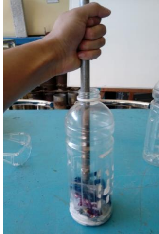
Fotografía 2-5. Compactado de las bolsas plásticas. Fuente: Propia
