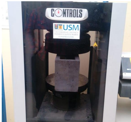
Fotografía 3-19. Bloque convencional en la prensa. Fuente: Propia
