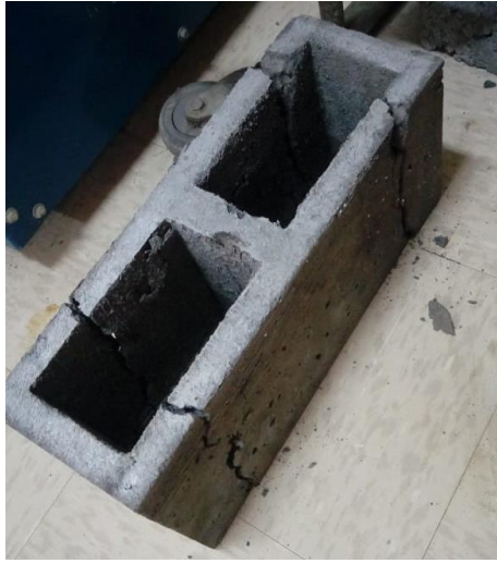
Fotografía 3-17. Bloque convencional después de ensayar a los 7 días Fuente: Propia
