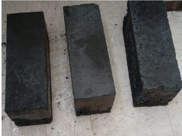
Fotografía 2-30. Bloques de hormigón con eco-ladrillo desmoldados. Fuente: Propia
