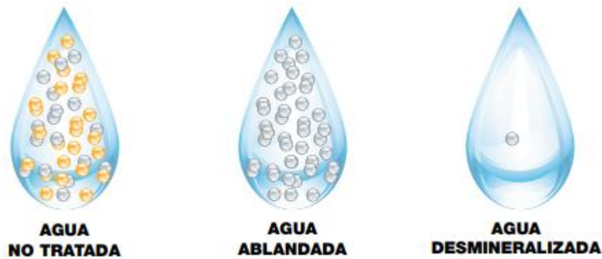
Figura N° 8. Calidades del agua. Fuente [14]
