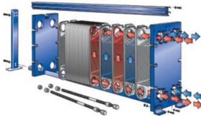
Figura N° 13. Capacidad de ampliación intercambiador de placa. Fuente [16]
