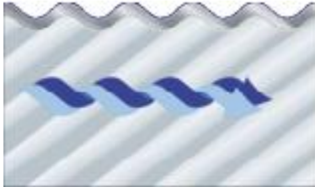
Figura N° 12. Canales en intercambiadores. Fuente [16]
