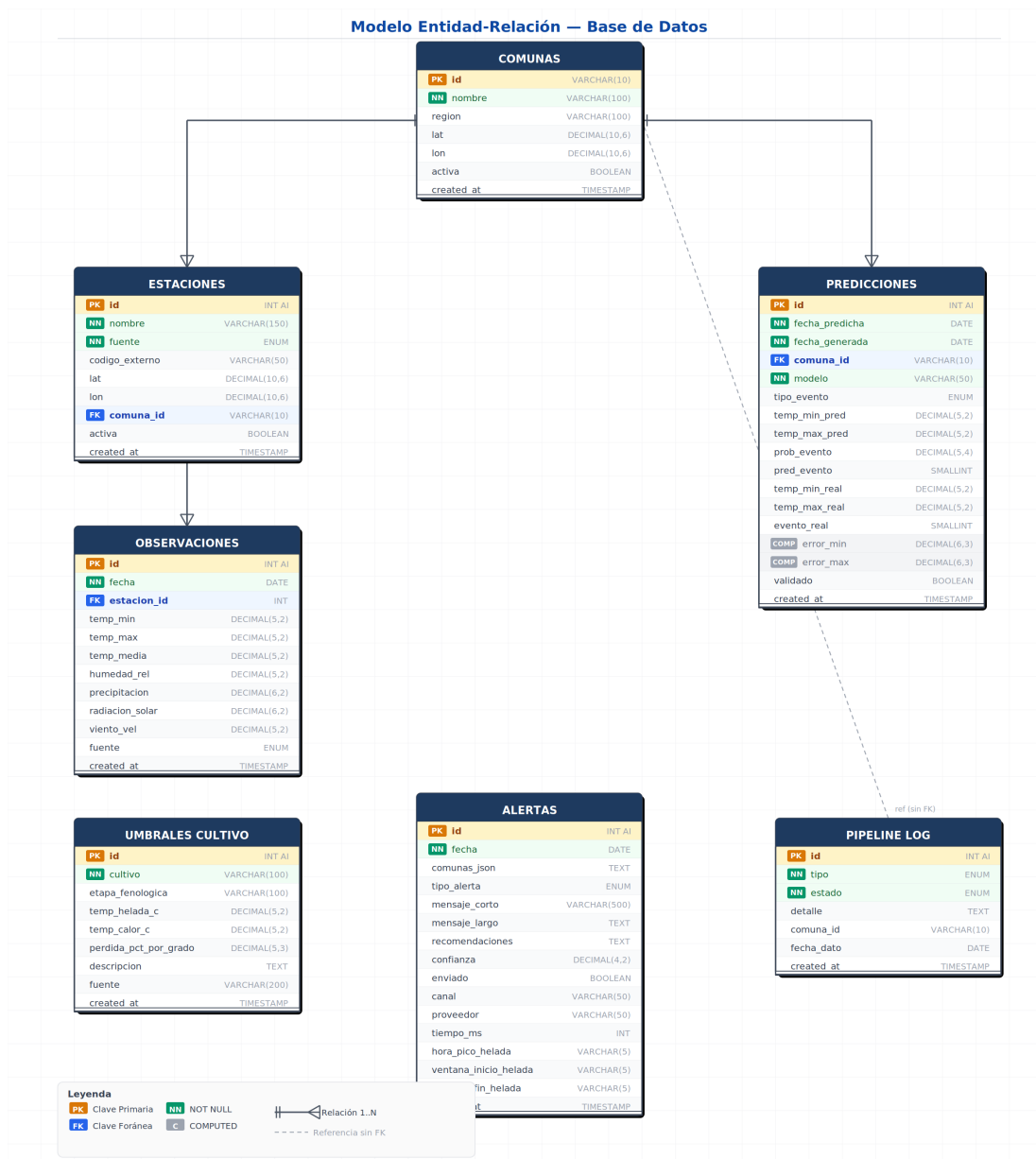
Figura B.1: Modelo físico de base de datos.
