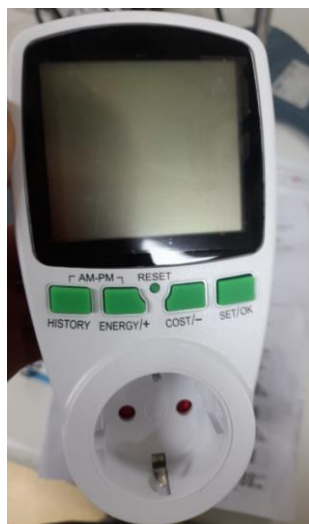
Figura 20. Medidor de potencia y energía (Power Meter, China).
