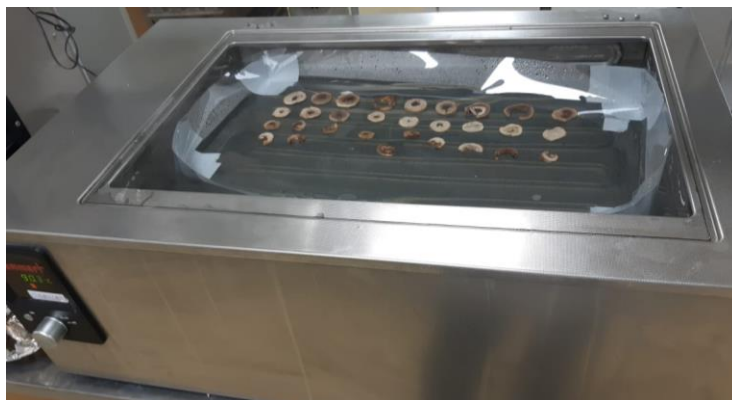
Figura 10. Ventana refractiva MERMMERT, modelo WNB22, Alemania
