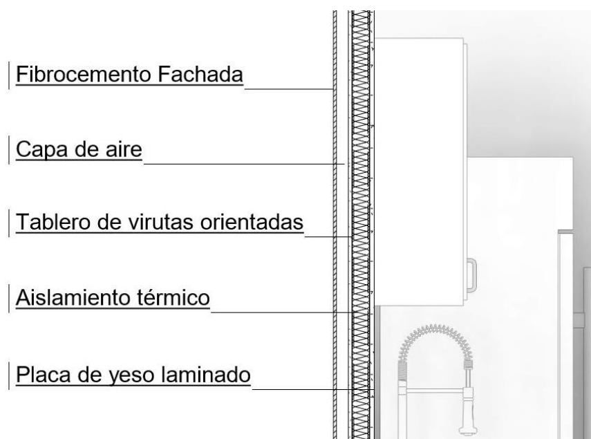
Ilustración 18 - Detalle en Corte de Fachada Ventilada.
