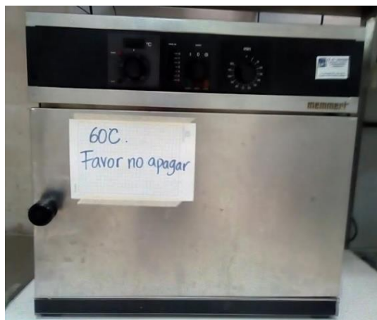
Figura 4.12. Estufa MEMERT utilizada para secar muestras de biomasa del cultivo a 80°C. Fuente: Elaboración propia
