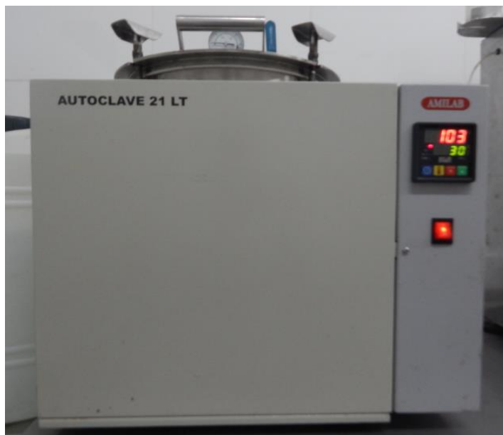
Figura 4.7. Autoclave marca AMILAB modelo mx-80 utilizado para esterilizar material y medios de cultivo. Fuente: Elaboración propia.
