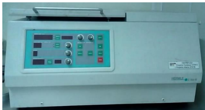
Figura 4.9. Centrifuga HERMLE modelo Z323K utilizada para procesar las muestras del cultivo. Fuente: Elaboración propia.
