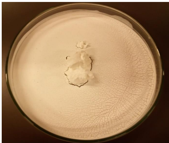
Figura 5.12. Recuperación del PHB del cultivo final. Fuente: Elaboración propia
