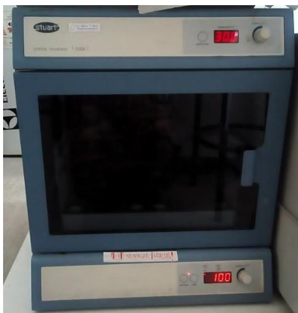
Figura 4.6. Shaker orbital utilizado para el cultivo de la cepa en placas y en matraces. Fuente: Elaboración propia
