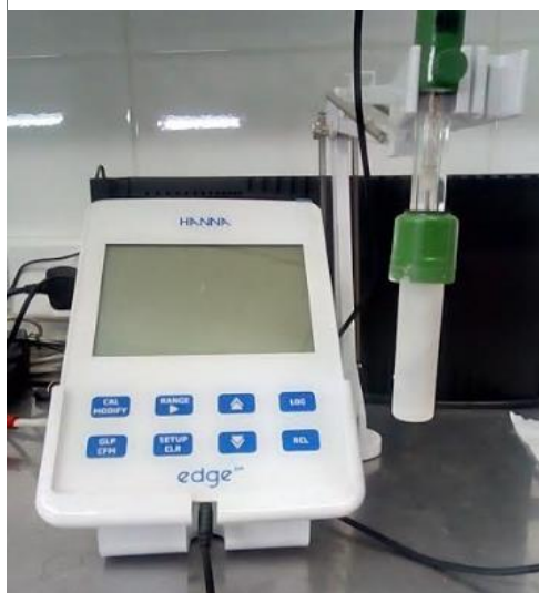
Figura 4.14. pH-ímetro marca HANNA modelo edge utilizado para monitorear el pH del cultivo. Fuente: Elaboración propia
