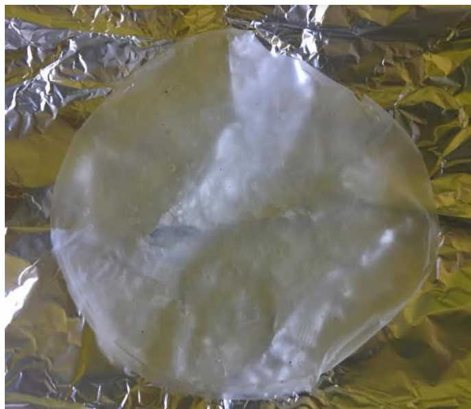
Figura 5.13. Film de PHB extraído del caldo de cultivo final. Fuente: Elaboración propia.
