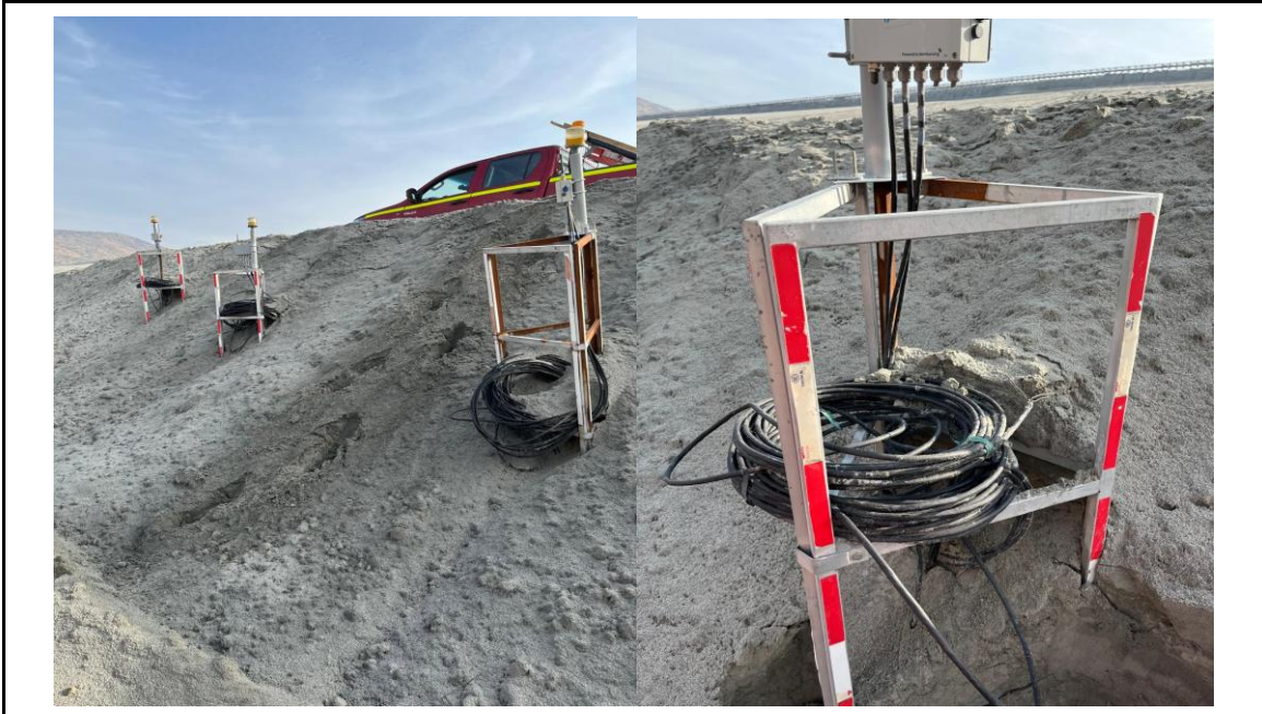
FIGURA 1.51. correspondiente a piezómetros nudo 09 tapados con relave
