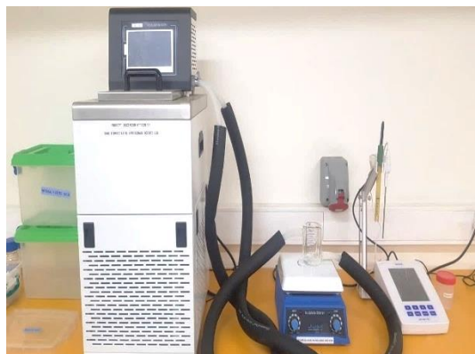
Figura 3-6 Baño de recirculación SCIENTZ-BIO, modelo DC-1006 [33].
