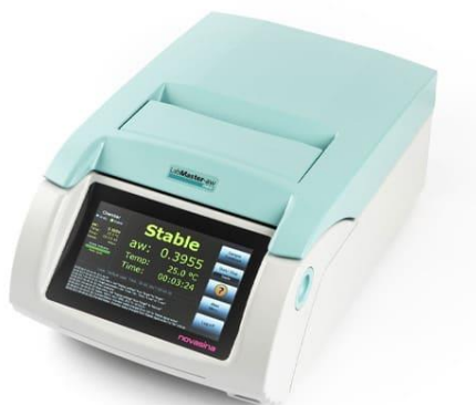
Figura 3-8 Equipo de medición de actividad de agua Novasina LabMaster-aw neo [35].
