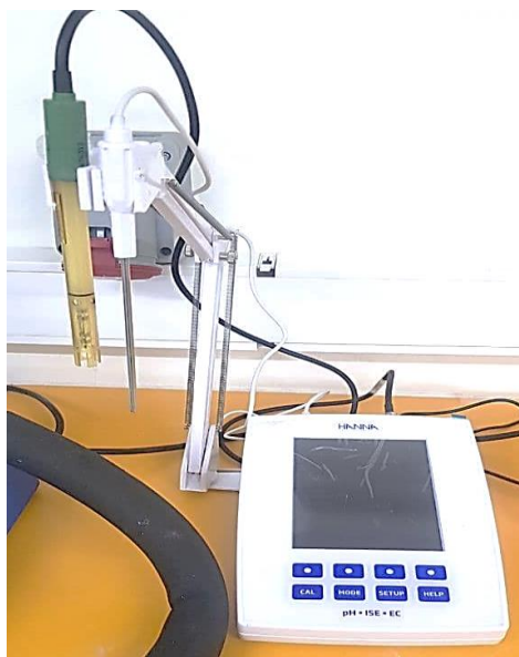
Figura 3-5 Medidor de Laboratorio de sobremesa HANNA INSTRUMENTS RI5522 [31], [32]
