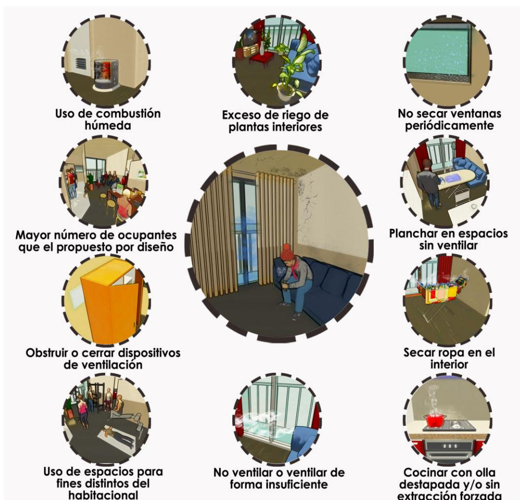
Figura 94: Prácticas peligrosas en el interior de una vivienda.
