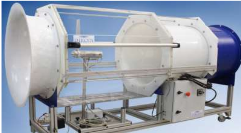
Figura 14: Banco de prueba de aerogenerador de baja potencia, DIKOIN
