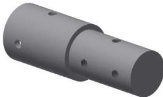
Figura 38: Esquema de la pieza para sujetar el aerogenerador al mástil
