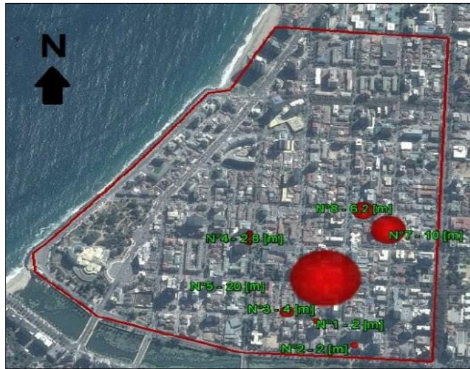
Figura 4: Mapa licuefacción sismo de magnitud Mw=9.0 propuesto por De Vidts, D. et al.
