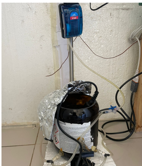
Figura 6: Fotografía del reactor biológico tipo Batch utilizado en la etapa de enriquecimiento del inóculo nitrificante.
