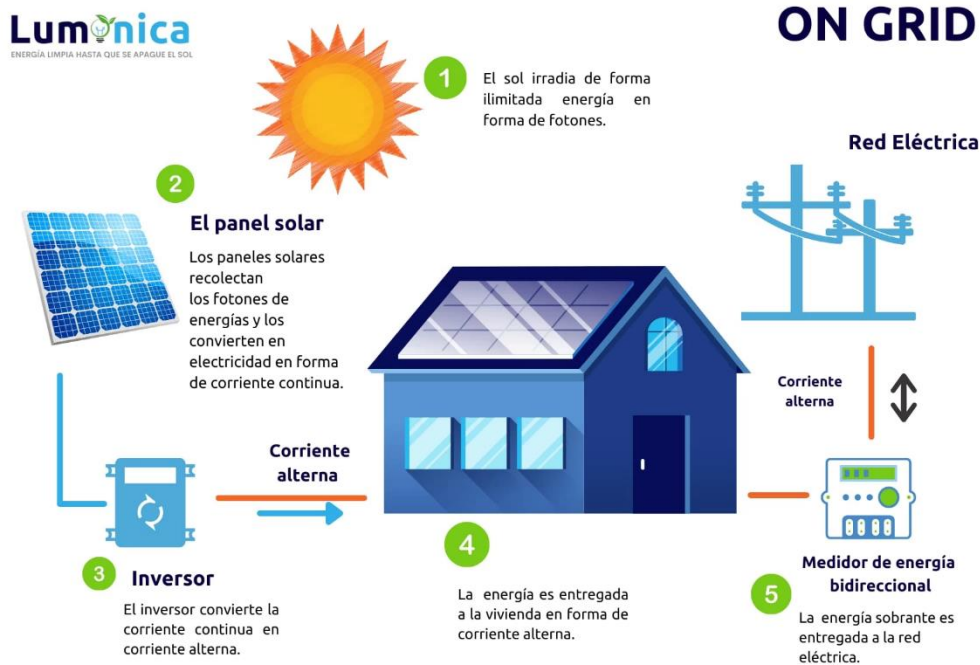
Figura 2.8 Funcionamiento Sistema ON-GRID
