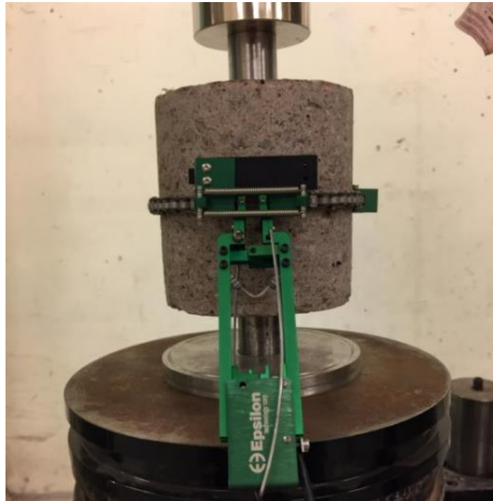
Figura 13- Cadena Extensometrica montada en cilindro de 100 mm
