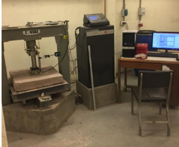
Figura 17- Ensayo de panel EFNARC.
