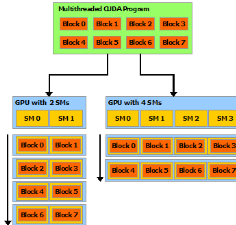
Figura 6: Asignación de ejecución de bloques en diferentes SM. A mayor cantidad de multiprocesadores, mayor es el paralelismo alcanzado. Fuente: CUDA C Programming Guide v11.2
