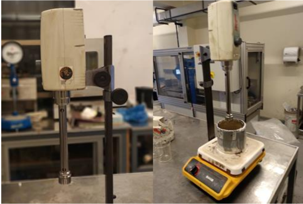
Figura 3-8: Sistema de mezclado montado.
