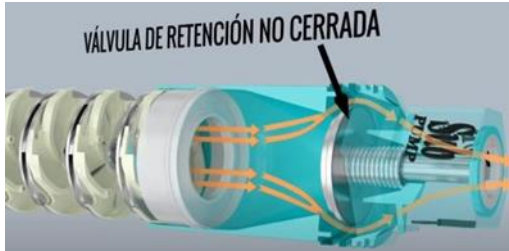
Figura 1.14: Funcionamiento de válvula de retención no cerrada.
