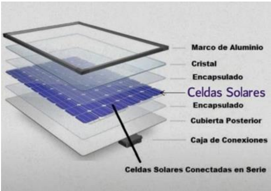
Figura 1.7: Interior de un panel solar.
