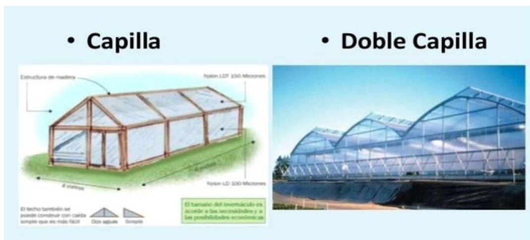
Figura 3 “Invernadero tipo capilla”
