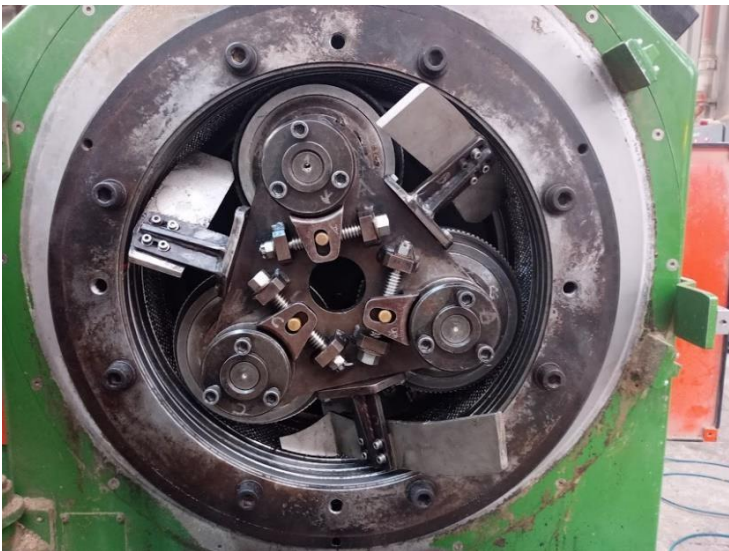
Figura 3-20. Sistema compactación prensa Mabrik. Fuente: Autoría propia. Imagen registrada en terreno
