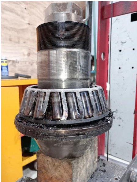
Figura 3-22. Imagen de rodamiento deteriorado de rodillos prensa Mabrik. Fuente: Autoría propia. Imagen registrada en mantenimiento a prensa Mabrik
