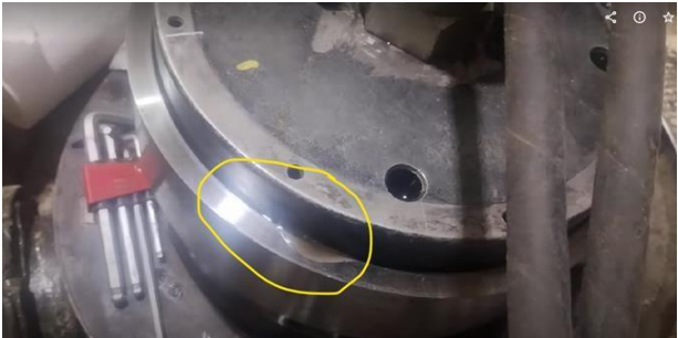
Figura 3-9. Filtración aceite en tuerca hidráulica. Fuente: Autoría propia. Imagen registrada desde terreno en prueba de estanqueidad realizada a tuerca hidráulica
