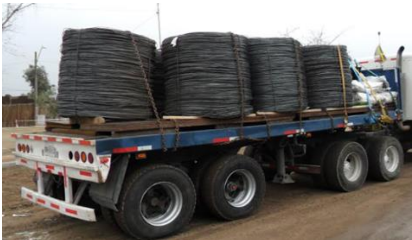
Figura A-2: Rampla plana de marca CETOL de 6,50 m de dos ejes para 18 T
