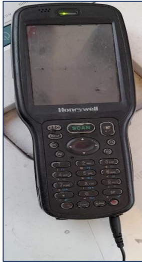
Figura 3-3. Lector código de barra, Fuente: Sistema Shipping Bar. Ingreso de información de pieza a fabricar.
