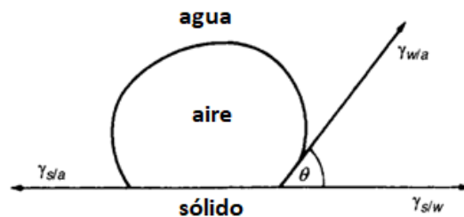
Figura 4: Fuerzas interactivas agregado partícula-burbuja [7].
