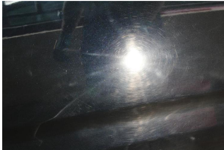
(Rayones superficiales de la pintura por mala técnica de lavado)
