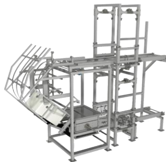
Figura 2 – 2: Esquema de vaciador de bins
