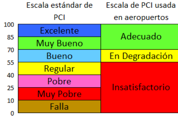
Figura 3-1: Escala de PCI estándar y de aeropuertos. DAP, 2017.
