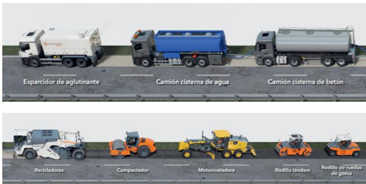
Figura 2-2: Tren de reciclado con asfalto espumado. Wirtgen, 2020.
