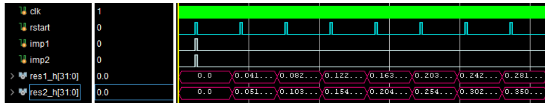
Figura 3.4: Simulación RTL del oscilador biquad con acercamiento
