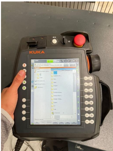
Figura 3.2 – 3.3 referente, controlador y programador KUKA KR C4.
