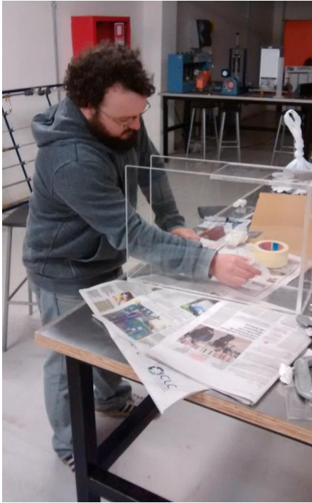
Figura 5.2 Pegado estanque de regulación
