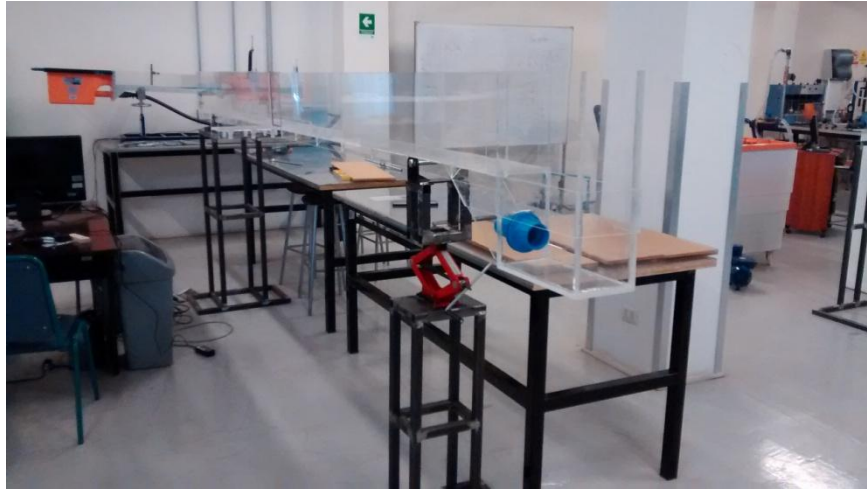
Figura 5.11 Canal montado sobre la estructura
