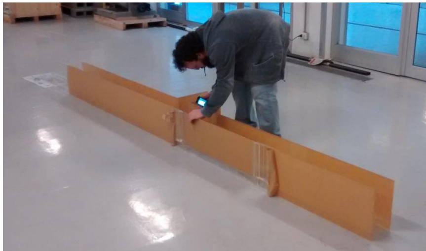
Figura 5.4 Armado del canal
