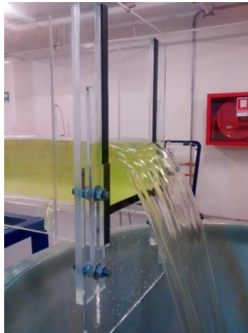
Figura 5.18 Vertedero frontal en funcionamiento
