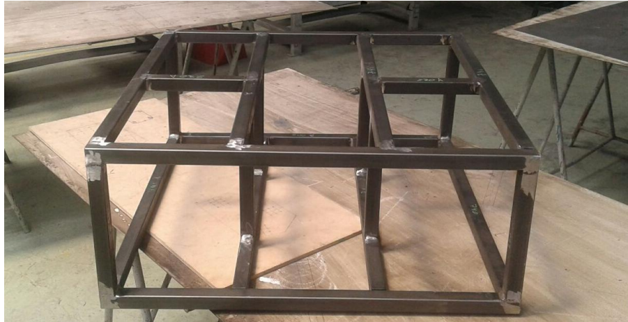
Figura 5.9 Base metálica de estanque
