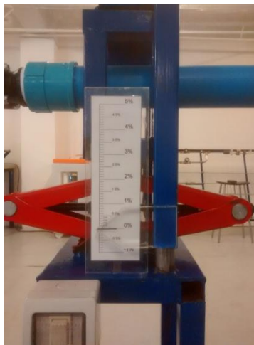
Figura 5.14 Mecanismo para entregarle pendiente al canal
