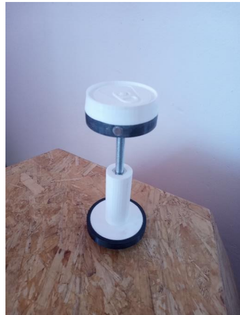
Imagen 67: funcionamiento del sistema tornillo - tuerca para la variación de la altura del prototipo.
