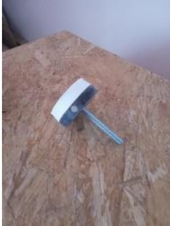
Imagen 65: Tapa impresa con tornillo instalado y asegurado.
