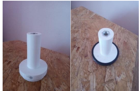
Imagen 64: Base impresa con tuerca instalada.
