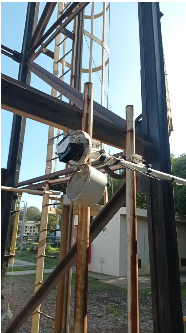
Figura 30 Sensor de temperatura a 2 metros de altura, estación meteorológica
