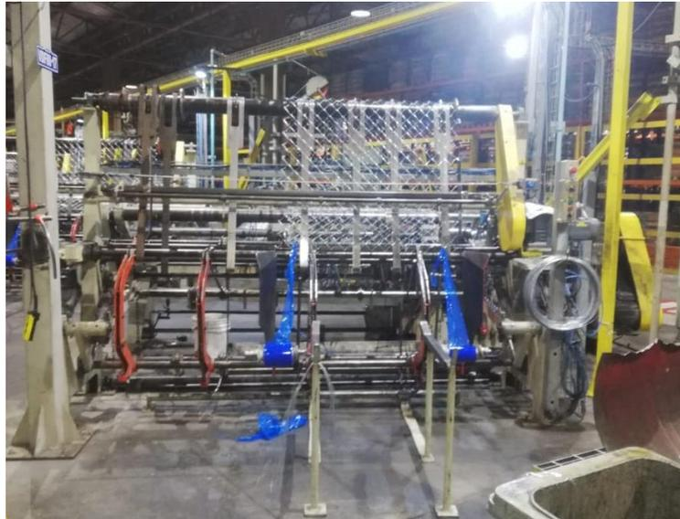
Ilustración 1-5: Máquina tejedora de mallas, Wafios VDF80 (fuente: inchalam)
