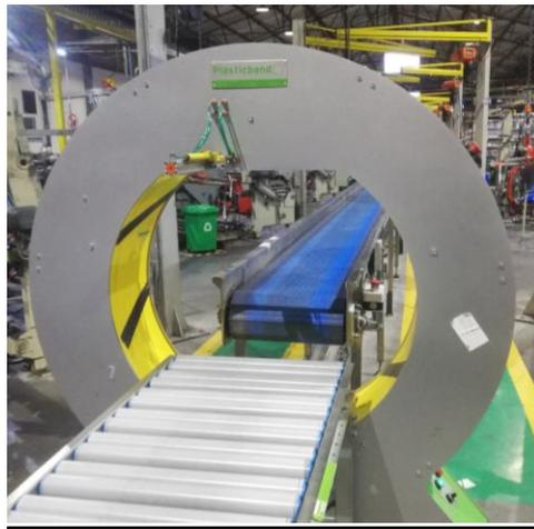
Ilustración 1-9: Orbital, encargado de poner film a los productos (fuente: inchalam)
