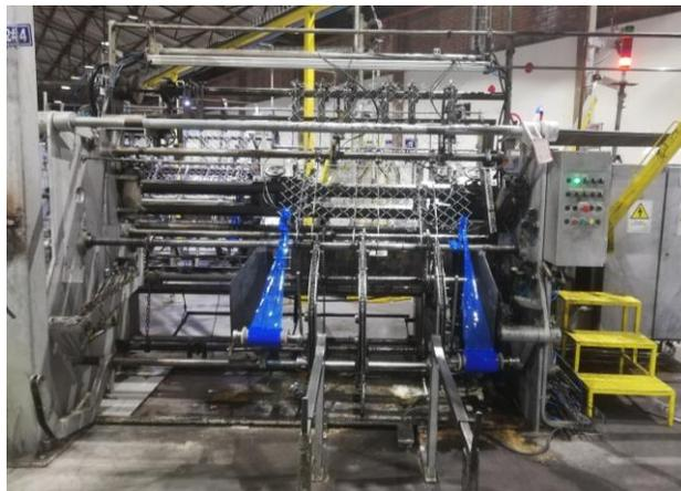
Ilustración 1-4: Maquina tejedora de mallas, Wafios DF32 (fuente: inchalam)
