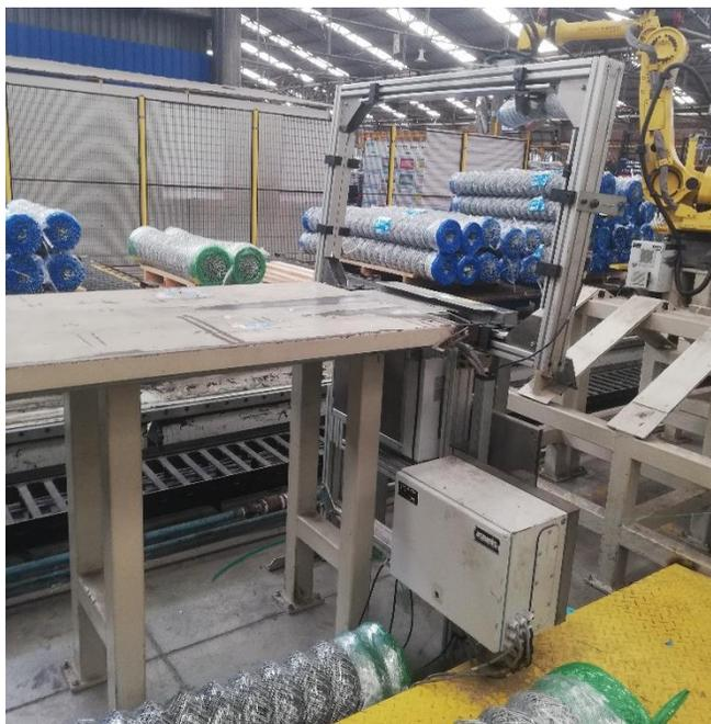
**Ilustración 3-2: Arco de mesa zunchadora (Fuente: Inchalam)**
