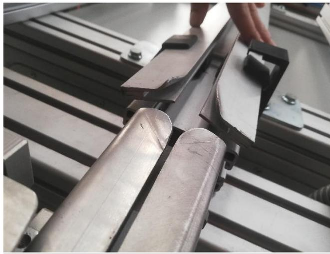
Ilustración 3-7: Sistema de guías del arco para zunchos (Fuente: Inchalam)
