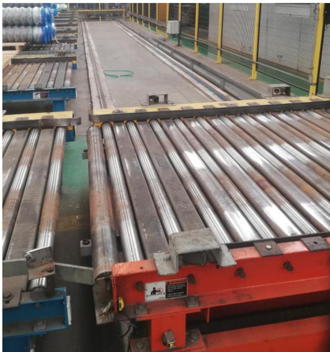
Ilustración 1-14: Carro de salida (fuente: inchalam)
