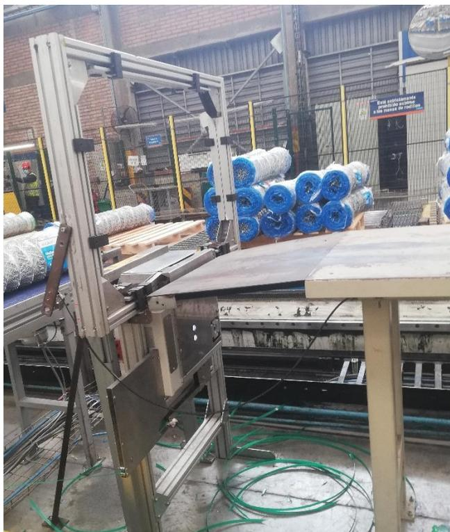
**Ilustración 3-3: Arco de mesa zunchadora, se observa la extensión realizada a la mesa original (Fuente: Inchalam)**
