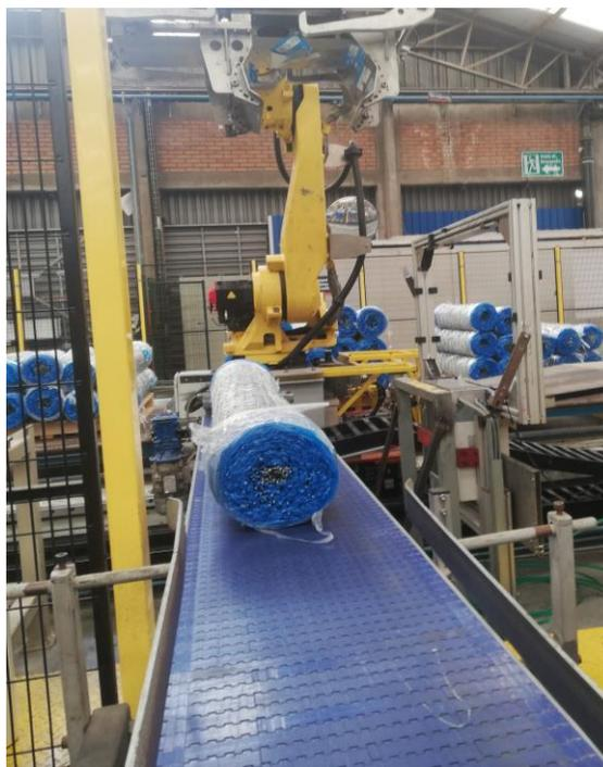
Ilustración 1-10: Ingreso a la celda robótica (fuente: inchalam)
