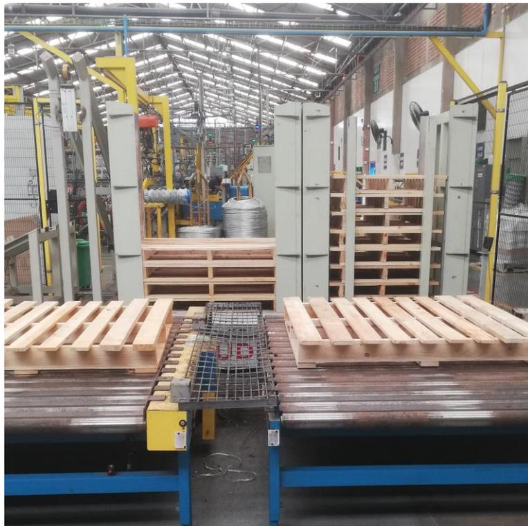
Ilustración 1-12: Dispensador de Palets (fuente: inchalam)
