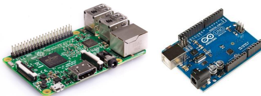
Ilustración 15: placas Raspberry Pi 3 y Arduino, de izquierda a derecha.
