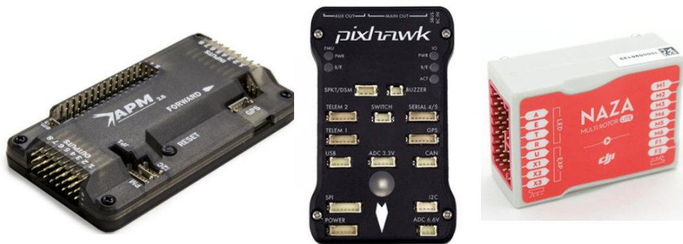
Ilustración 16: Algunas controladoras de vuelo, de izquierda a derecha APM, Pixhawk y NAZA, unas de las más usadas según desarrolladores.
