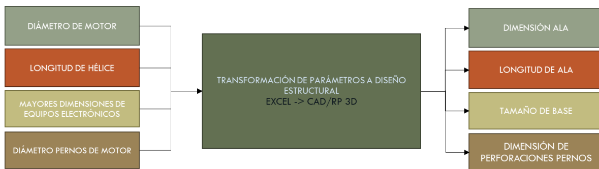
Ilustración 29: Influencias de dimensiones ingresadas por el usuario en el diseño del modelo CAD.
