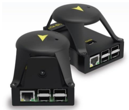
Ilustración 26: Erle-Brain3 con GPS incluido. Imagen de erlerobotics.com.
