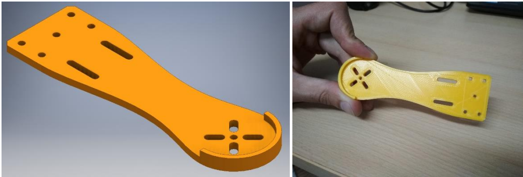
Ilustración 32: Diseño final de Ala Drone para caso de estudio.
