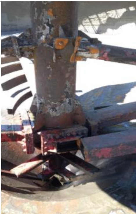
Imagen N°44 “Fractura en rastra”
