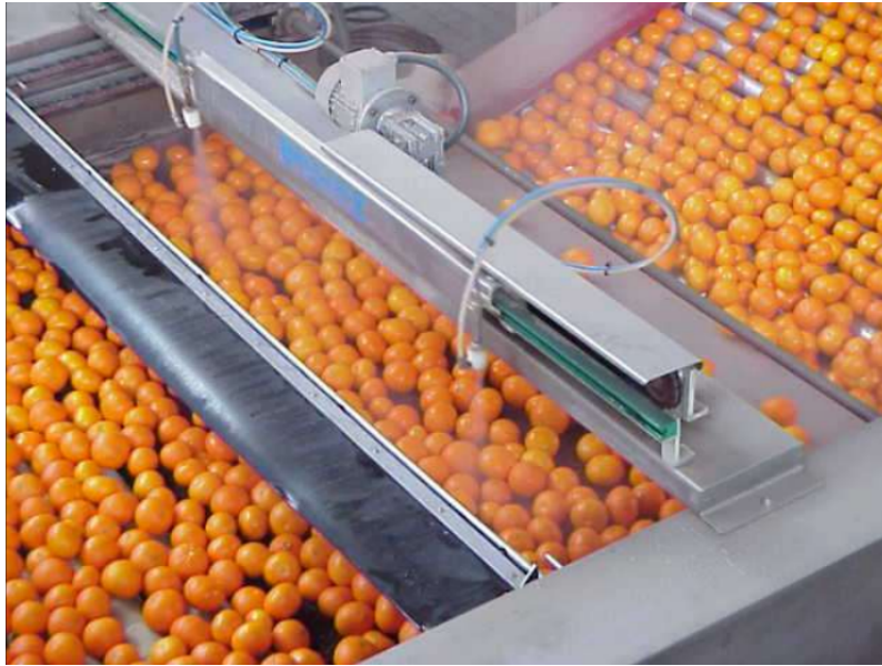
Figura 2.5: aplicación online mediante boquillas dispensadoras
