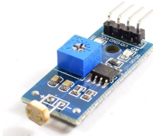
Figura 4.4: Modulo detector de luz con fotodetector LDR
