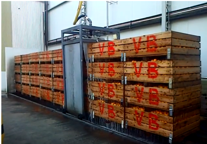
Figura 2.2: Drencher de cabina
