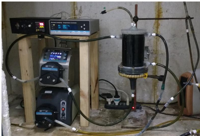
Figura 10: Reactor UAF y equipos adicionales
