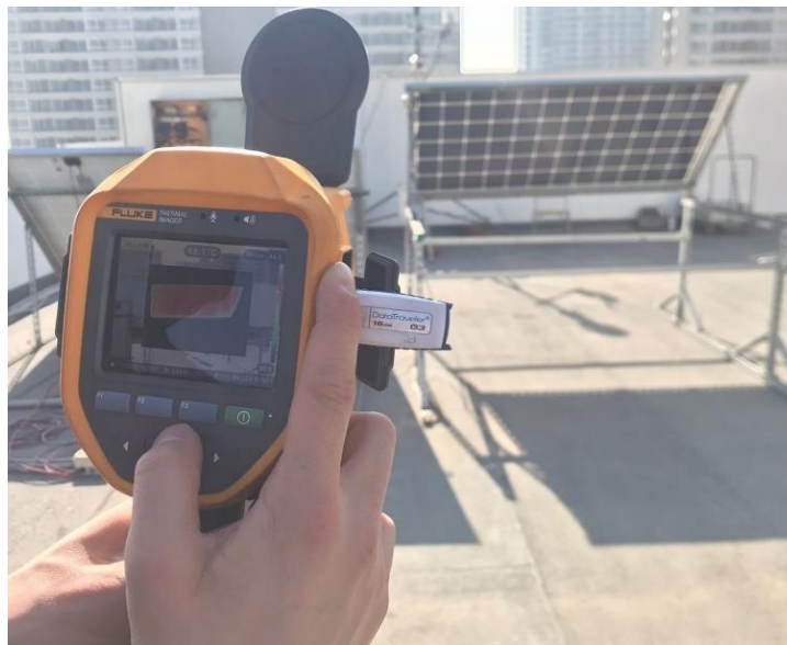
Figura 6-9: Prueba de termografía bajo condiciones estacionarias.
