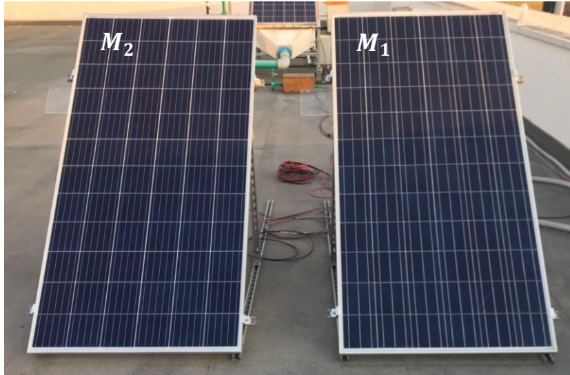
Figura 4-1: Módulos monofaciales policristalinos del estudio.
