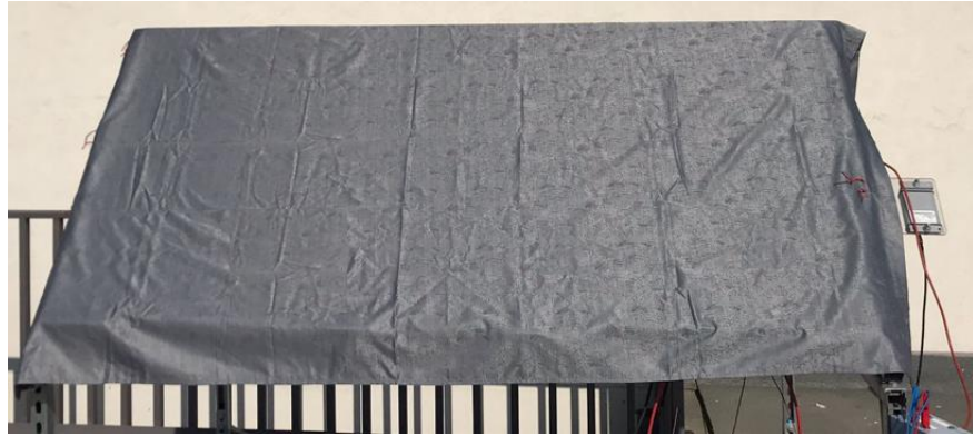
Figura 6-7: Medición de curva I-V en la cara trasera de módulo bifacial con su cara frontal cubierta con cortina blackout.
