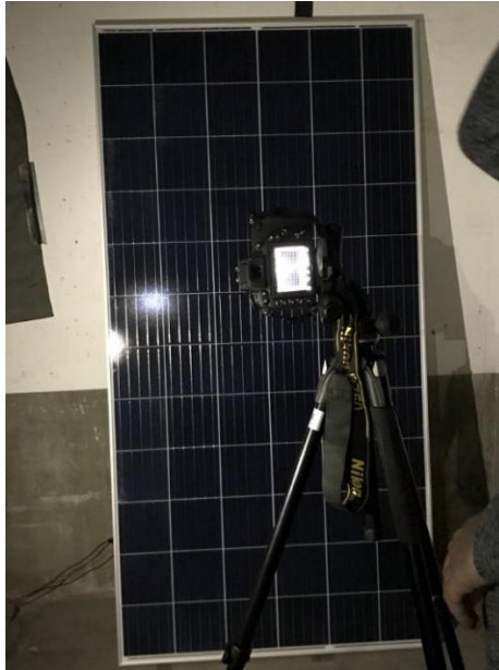
Figura 6-22: Procedimiento de electroluminiscencia.
