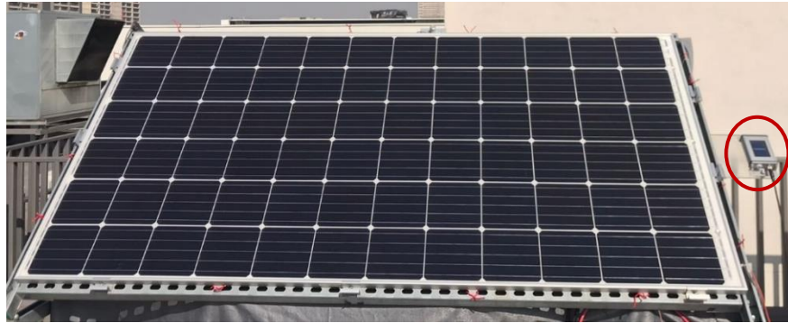
Figura 6-5: Medición de curva I-V en la cara frontal de módulo bifacial, con celda de referencia en el plano de medición y su cara posterior cubierta con una cortina blackout.
