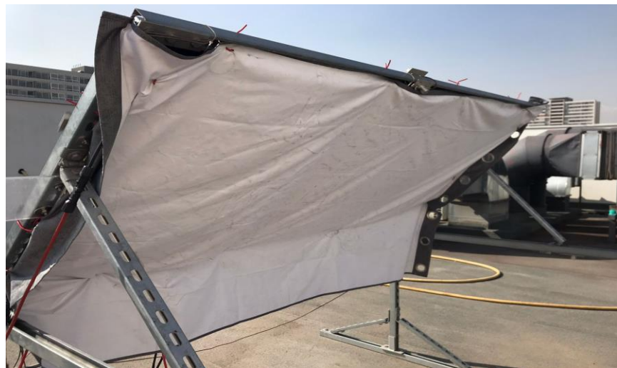
Figura 6-6: Medición de curva I-V en la cara frontal de módulo bifacial, con cortina blackout para cubrir su cara posterior.
