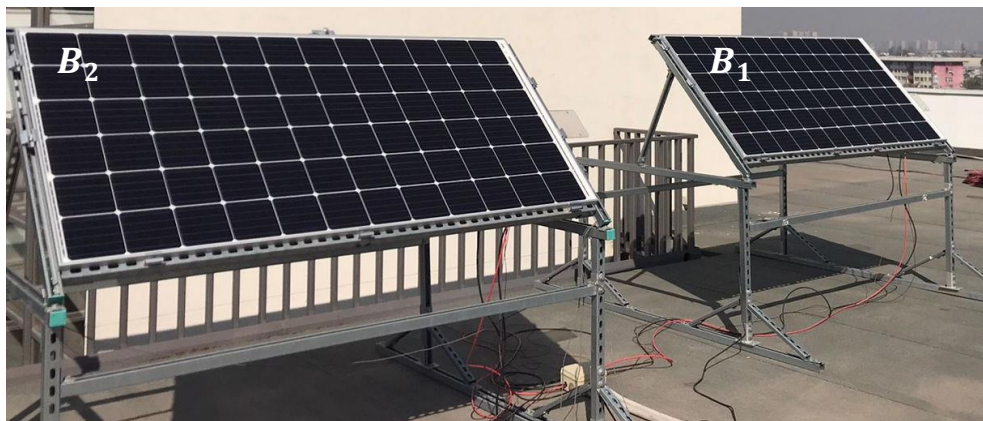
Figura 4-6: Módulos bifaciales monocristalinos con dos años de exposición ( B_1 ) y sin exposición ( B_2 ).
