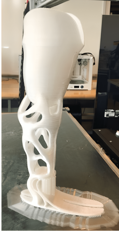
Figura 3.14: Prótesis monoblock personalizada impresa en PA-12 De Vivo Nicoloso et al. (2021) .
