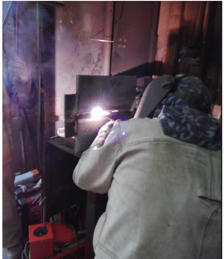
Ilustración 21, Soldador Calificando en WPS: WSM-8/8-1055
