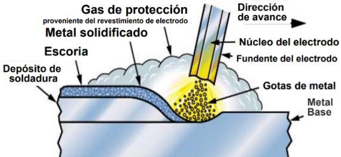
Ilustración 17, Ilustración Fundamentos Proceso Smaw
