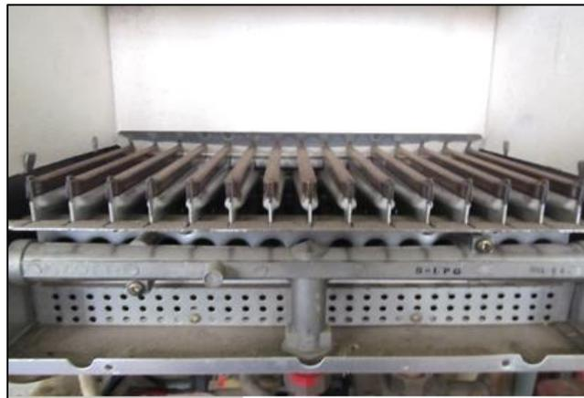
**Figura 3.7:** Inyectores de la llama libre en la caldera comercial ensayada.
