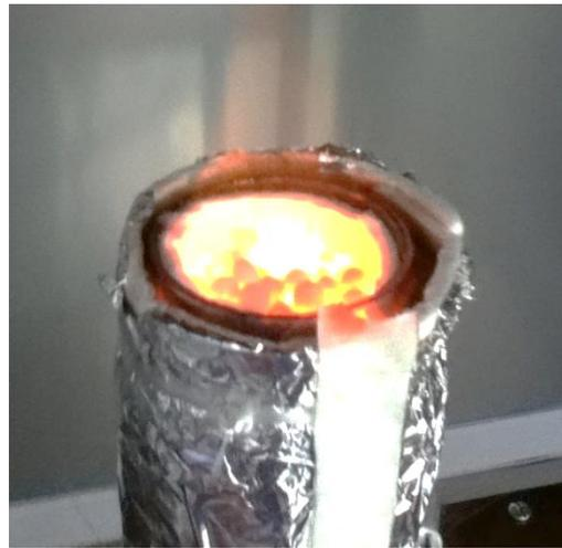
**Figura 5.4:** Combustión en medios porosos con la llama insertada en el medio para un flujo másico de 1,7 [lt/min] de gas natural con un lambda de 1,2.
