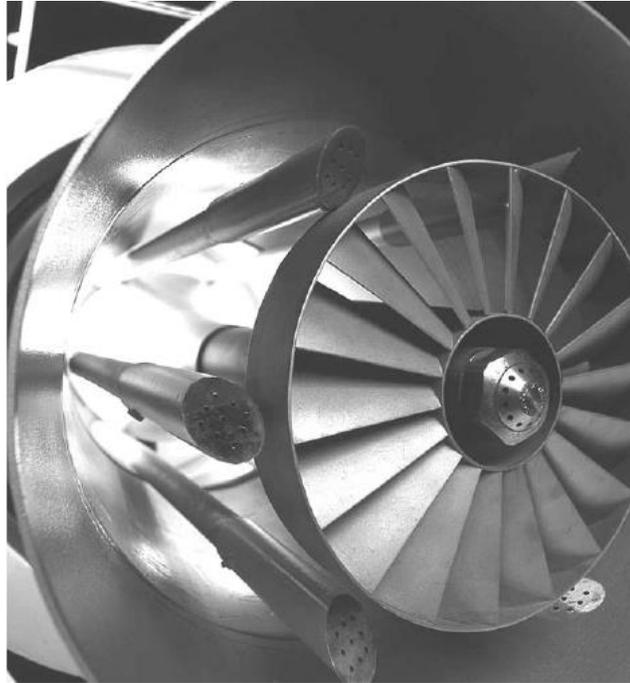
**Figura 2.3:** Inyector de bajo NOx funcionando con aire por etapas y los inyectores de gases. [2]
