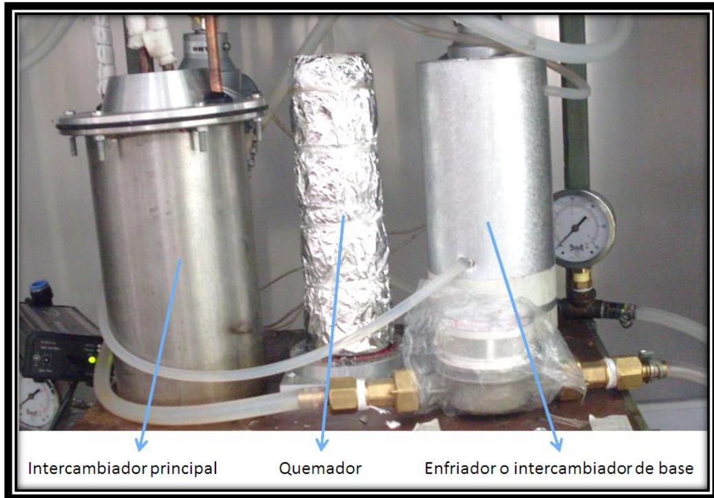
**Figura 5.11:** intercambiador principal (parte superior) y enfriador (parte inferior) del dispositivo desmontados.
