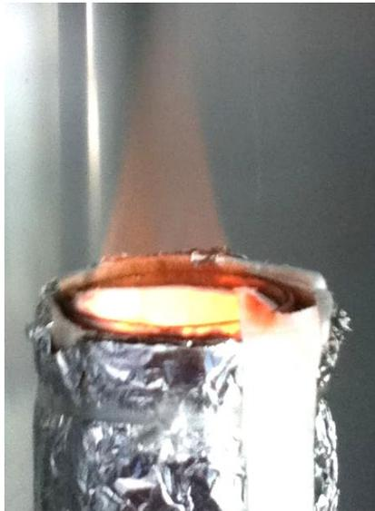
**Figura 5.3:** quemador de medios porosos en puesta en marcha para un caudal de 1,7 [lt/min] de gas natural con lambda de 0,9.
