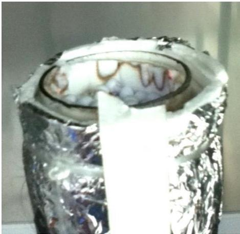
**Figura 5.2:** Inicio de la combustión en medios porosos para 1 [lt/min] de gas natural con un valor lambda de 1.
