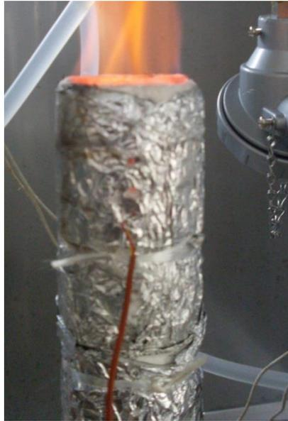
**Figura 5.6:** Muestra la termocupla tipo K de contacto en los puntos de patrones equidistantes de 1 [cm] para la medición de temperatura de pared.
