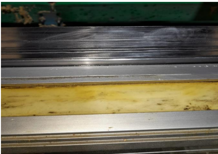
Ilustración 2- 21: Daños en bancadas
