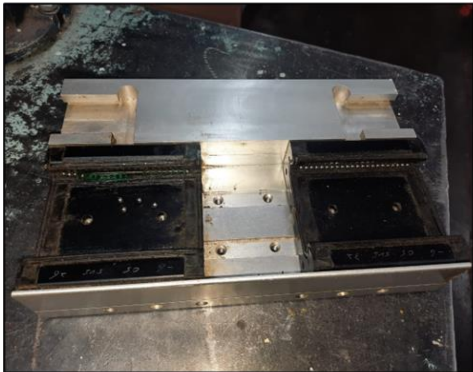
Ilustración 2- 19: Daños en rodamientos por falta de lubricación
