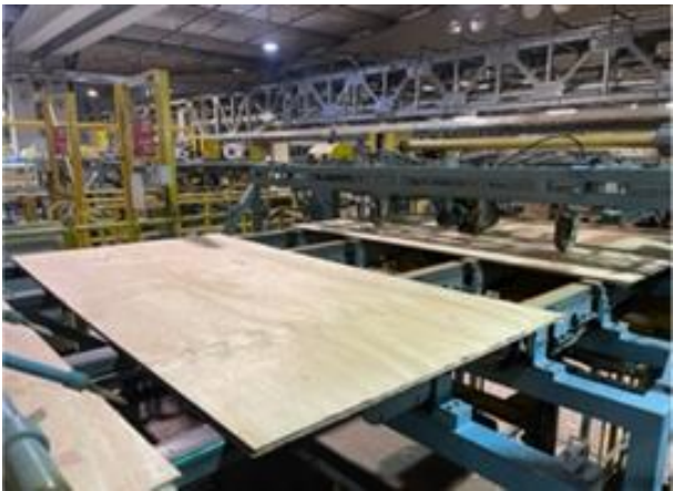
Ilustración 2- 13: Alimentación de tableros.
