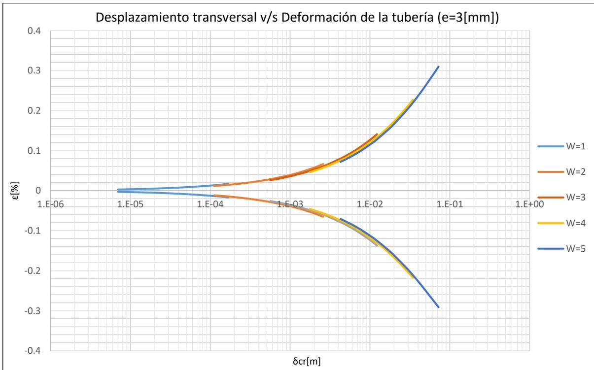
Gráfico 13-4: Desplazamiento transversal v/s Deformación de la tubería, Tubería de Acero de espesor 3[mm], Suelo de Arena Fina.
