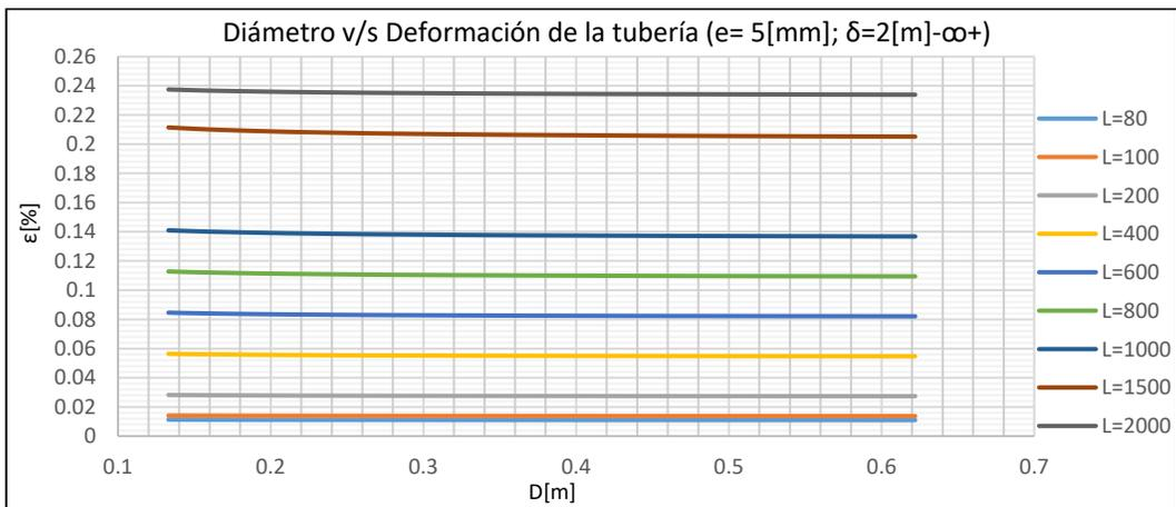
Gráfico 13-251: Diámetro v/s Deformación de la tubería, Tubería de Acero de espesor 5[mm], desplazamiento longitudinal mayor a 2[m], Suelo Limoso de baja Plasticidad.
