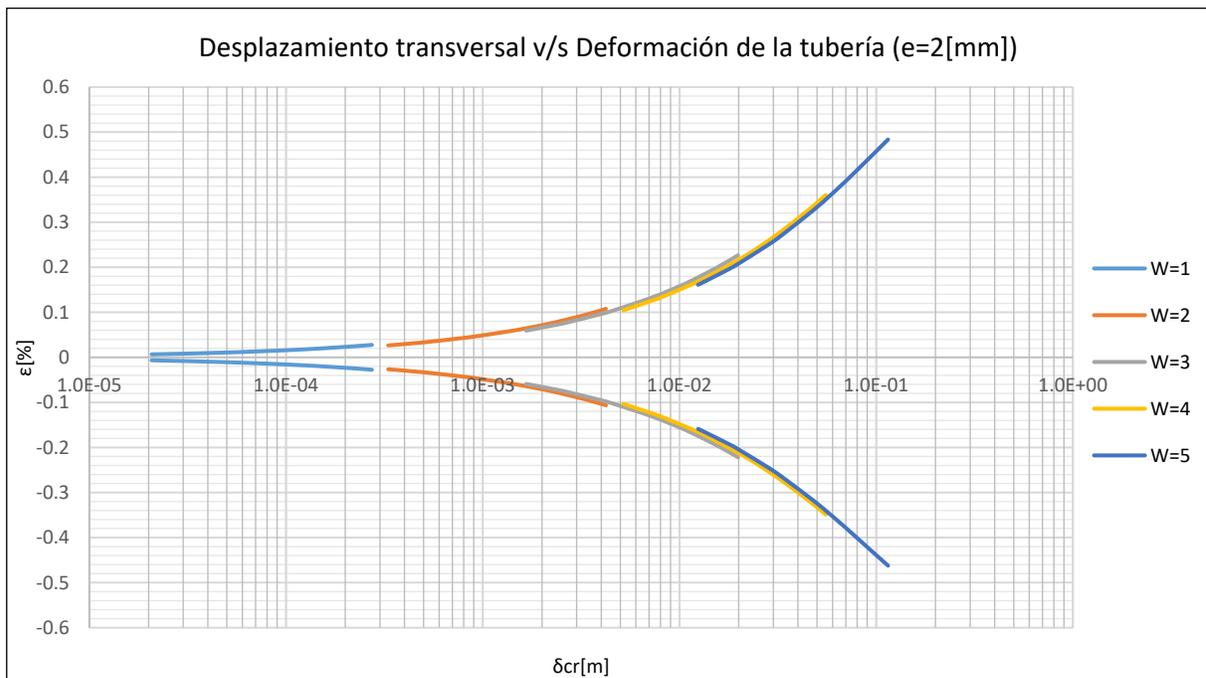
**Gráfico 13-50: Desplazamiento transversal v/s Deformación de la tubería, Tubería de Acero de espesor 2[mm], Suelo Limoso de Baja Plasticidad.**
