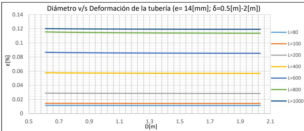
Gráfico 13-221: Diámetro v/s Deformación de la tubería, Tubería de Acero de espesor 14[mm], desplazamiento longitudinal entre 0.5 [m] y 2[m] ], Suelo de Arena Fina.
