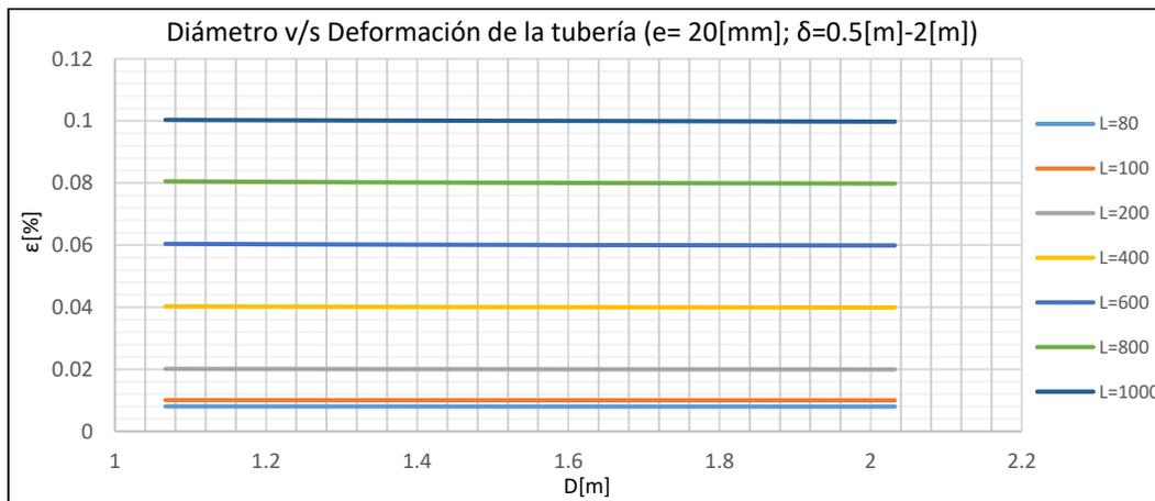
Gráfico 13-227: Diámetro v/s Deformación de la tubería, Tubería de Acero de espesor 20[mm], desplazamiento longitudinal entre 0.5 [m] y 2[m] ], Suelo de Arena Fina.
