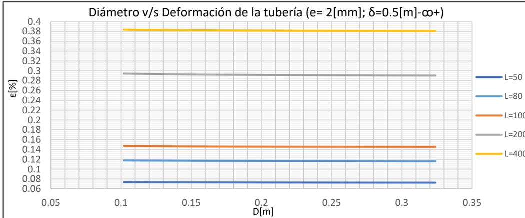
Gráfico 13-229: Diámetro v/s Deformación de la tubería, Tubería de Acero de espesor 2[mm], desplazamiento longitudinal mayor a 0.5 [m] , Suelo Arena Gruesa.
